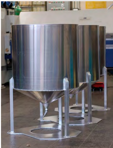
Behälter für Schäume im Rahmen von Brandlöschversuchen
