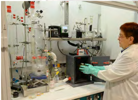
Blausäureprüfstand für Filter
