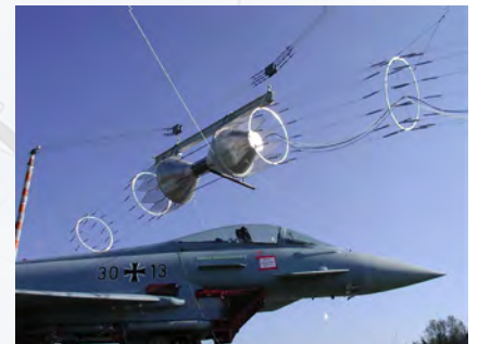
NEMP-Erprobung Eurofighter (mobile Dipolantenne)
