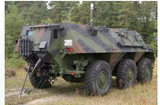
Heckansicht des AC-Spürpanzers FUCHS mit ausgefahrener C-Spürsonde und abgesetzten Spürrädern
