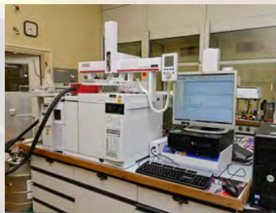
Analyse von VOCs mittels Thermodesorption und GC-MS (Gaschromatographie mit gekoppelter Massenspektrometrie)
