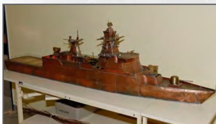
Maßstabsgetreues Modell zur Verifizierung numerischer Codes
