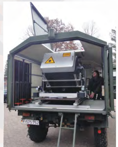
Schwenkvorrichtung Lasereinheit BALI und deren Integration in ein BW-Fahrzeug 2t
