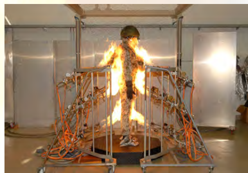
Prüfung der Brandbeständigkeit und thermischen Isolationswirkung von Einsatzbekleidung
