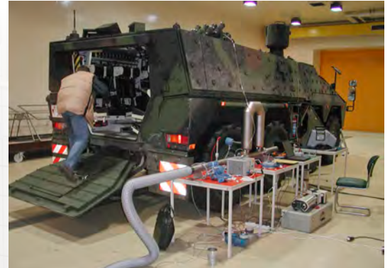
Systemuntersuchung zum ABC-Kollektivschutz am Waffensystem GTK Boxer
