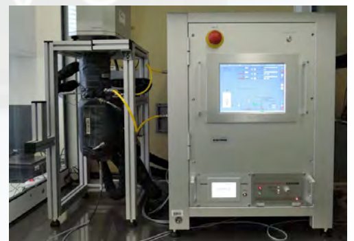
Magnetschwebewaage zur Generierung von hochverdünnten kampfstoffhaltigen Prüfgasen.
