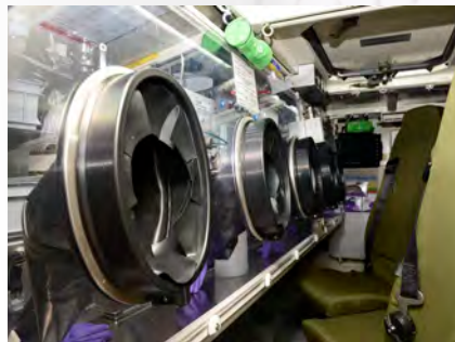
Feldfähige B-Laborinfrastruktur: BSL 3-Containment (Trägerplattform YAK)
