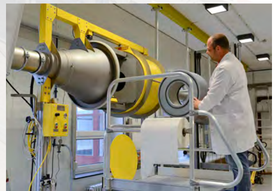
Durchlassgradprüfung von Filtermedien mit Aerosol
