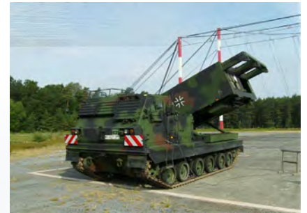
NEMP-Erprobung MARS GMLRS (Wellenleiter)
