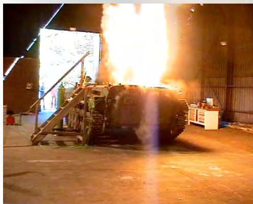
Erprobung einer Brandunterdrückungsanlage. Hier: Wirkung der standardisierten Verpuffung ohne Brandunterdrückungsanlage
