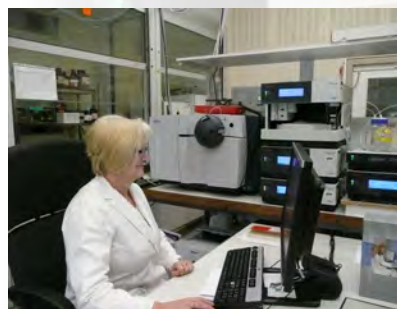
Spurenanalytische Untersuchung von Kampfstoffen in wässrigen Proben an der UHPLC-MS (ultra high performance liquid chromatography mass spectrometry)
