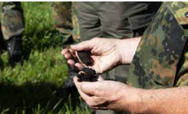
Anschließende Analyse der Bodenprobe. Der schwarze Boden hat einen hohen organischen Anteil (Torf) Quelle: AusbZPI/ Kurt
