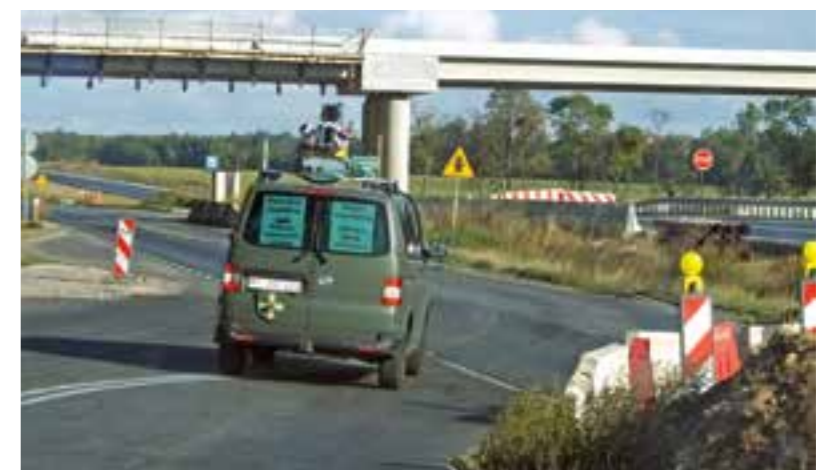
Erfassungsfahrt, Trägerfahrzeug VW Widder mit dem MSS Trimble MX9; Quelle: ZGeoBw
