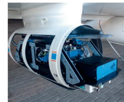
**Kompakte Größe: MACS ist recht leicht** und kann aufgrund seiner Bauweise mit unterschiedlichen Trägersystemen zum Einsatz gebracht werden. Jets kommen ebenso infrage wie Motorsegler oder Drohnen
