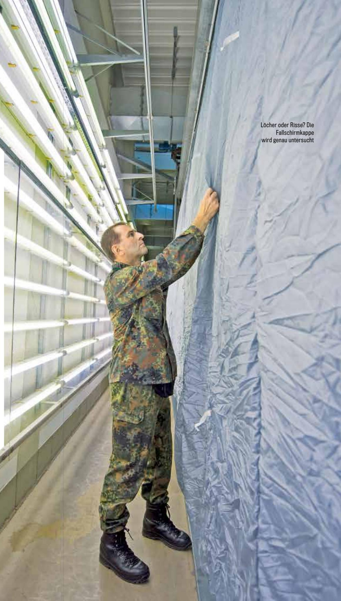
Löcher oder Risse? Die Fallschirmkappe wird genau untersucht
