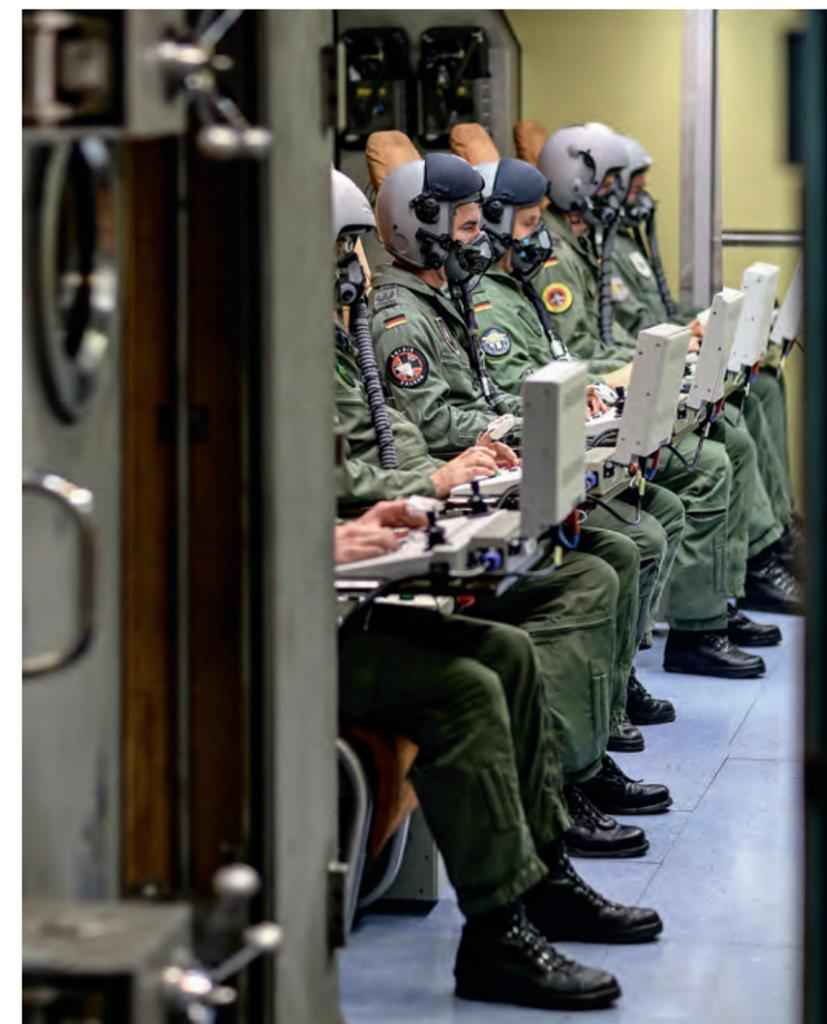
**In der Unterdruckkammer** werden die Umweltbedingungen in großen Höhen simuliert. Die Pilotinnen und Piloten müssen Aufgaben lösen, während die Sauerstoffzufuhr von außen gesteuert wird. Sie wissen nicht, wann genau der Sauerstoffgehalt nach unten reguliert wird.
