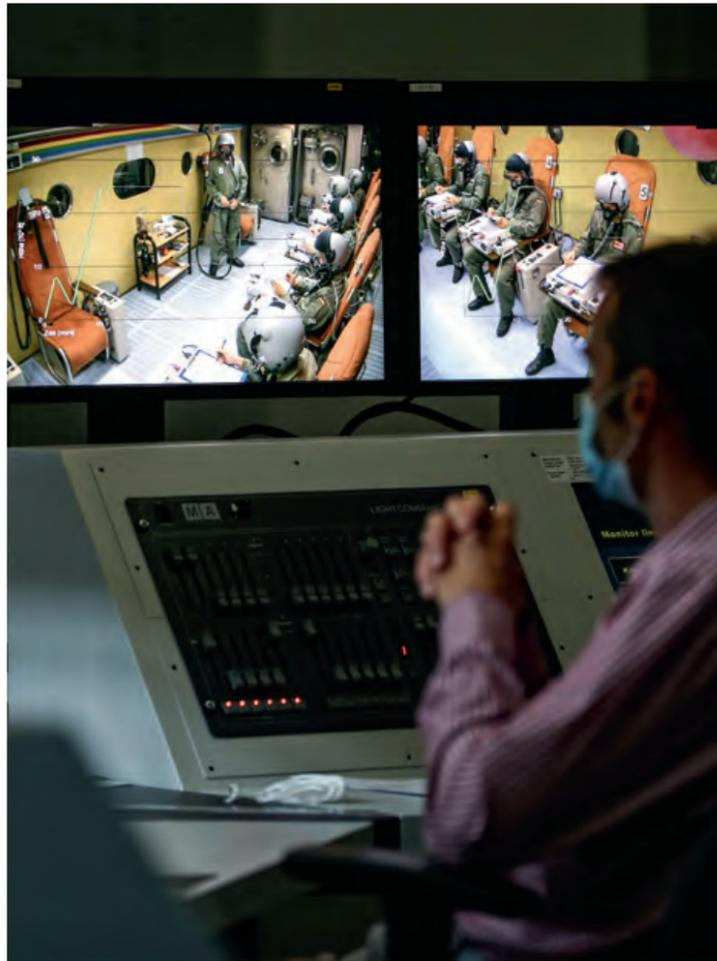
**Techniker im Kontrollraum** überwachen die Piloten in der Unterdruckkammer über Kameras und Bildschirme. Damit sollen Gesundheitsrisiken minimiert und Verhaltensänderungen schnell erkannt werden.
