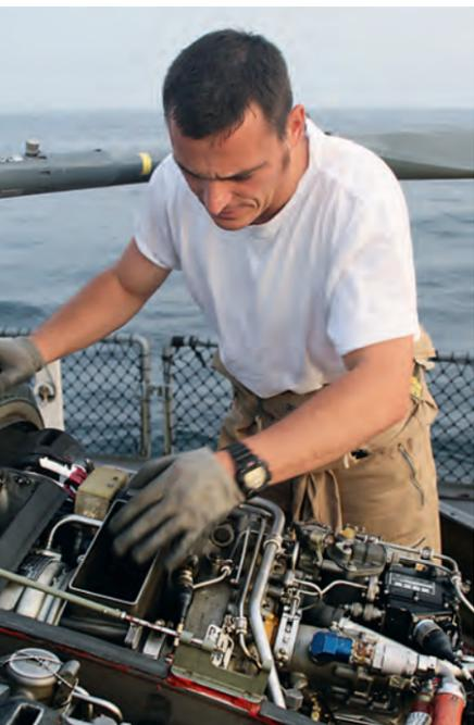
Bordmechaniker bei der Wartung eines Sea Lynx Hubschraubers an Deck
