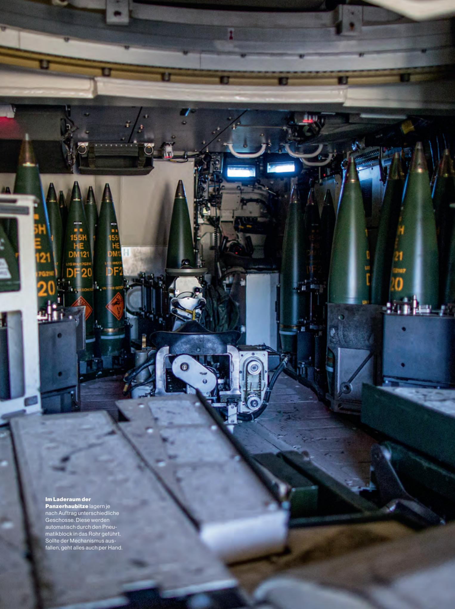
**Im Laderaum der Panzerhaubitze** lagern je nach Auftrag unterschiedliche Geschosse. Diese werden automatisch durch den Pneumatikblock in das Rohr geführt. Sollte der Mechanismus ausfallen, geht alles auch per Hand.
