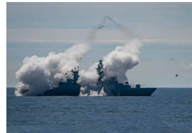
Die Korvette F 262 ERFURT verschießt zwei Luftziel-Flugkörper RAM (Rolling Airframe Missile) aus dem achteren und dem vorderen Launcher und schießt damit ein Drohnenziel ab.
