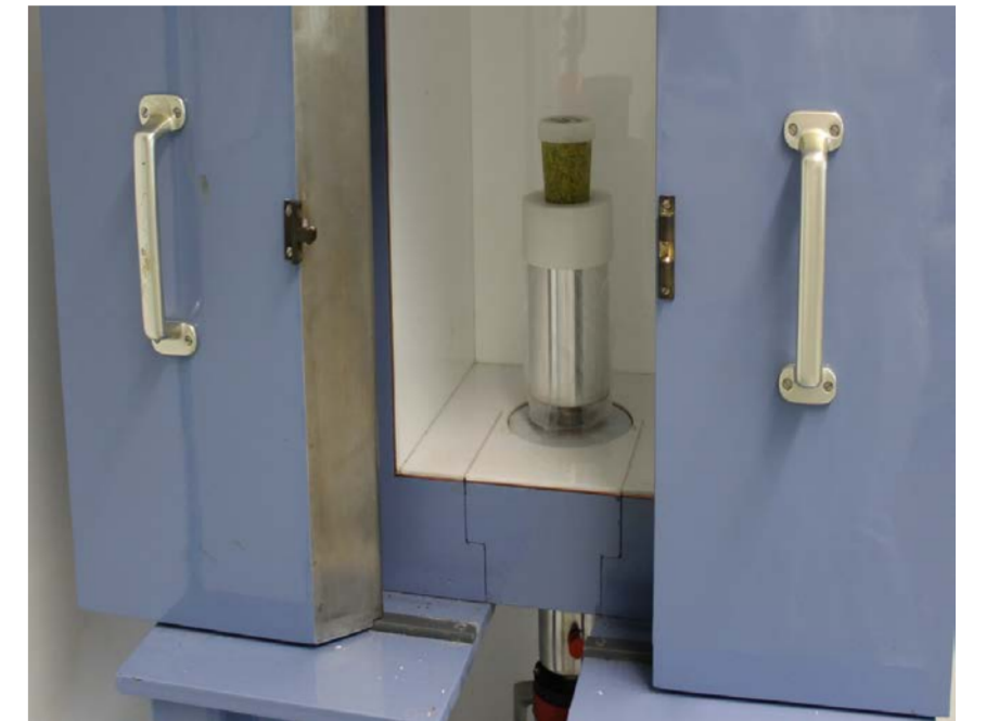
Abb: Messplatz mit Probe auf dem Kristall
