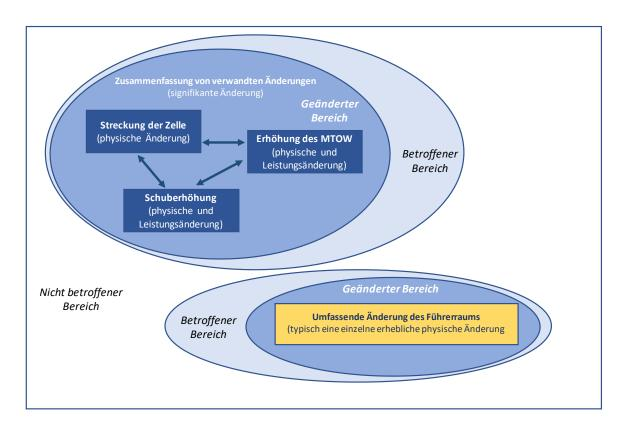
Abb. 6: Zusammenhängende und nicht zusammenhängede Änderung am Beispiel der Erhöhung der Passagierkapazität
