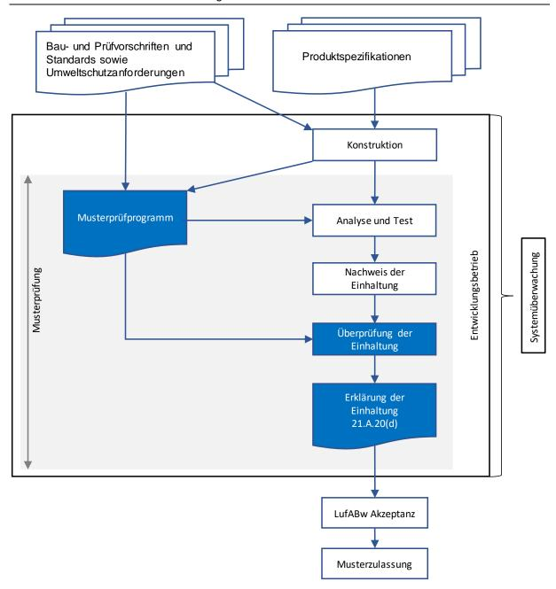
Abb. 9:Zusammenhänge zwischen Konstruktion, Konstruktionssicherung und Musterprüfung
