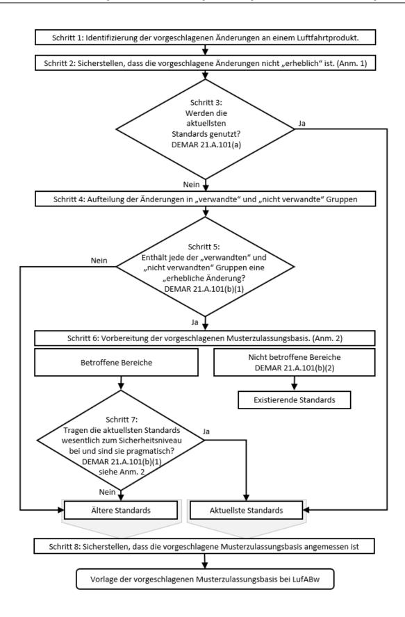
Abb. 5: Entwicklung einer vorgeschlagenen Musterzulassungsbasis für ein geändertes Produkt gemäß DEMAR 21
