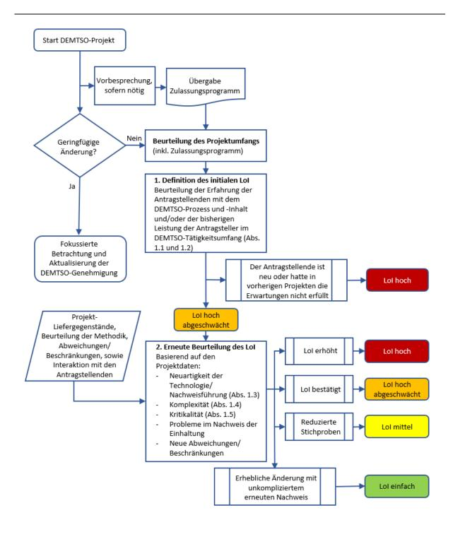
Abb. 17: Prozess zur Festlegung des Lol des LufABw
