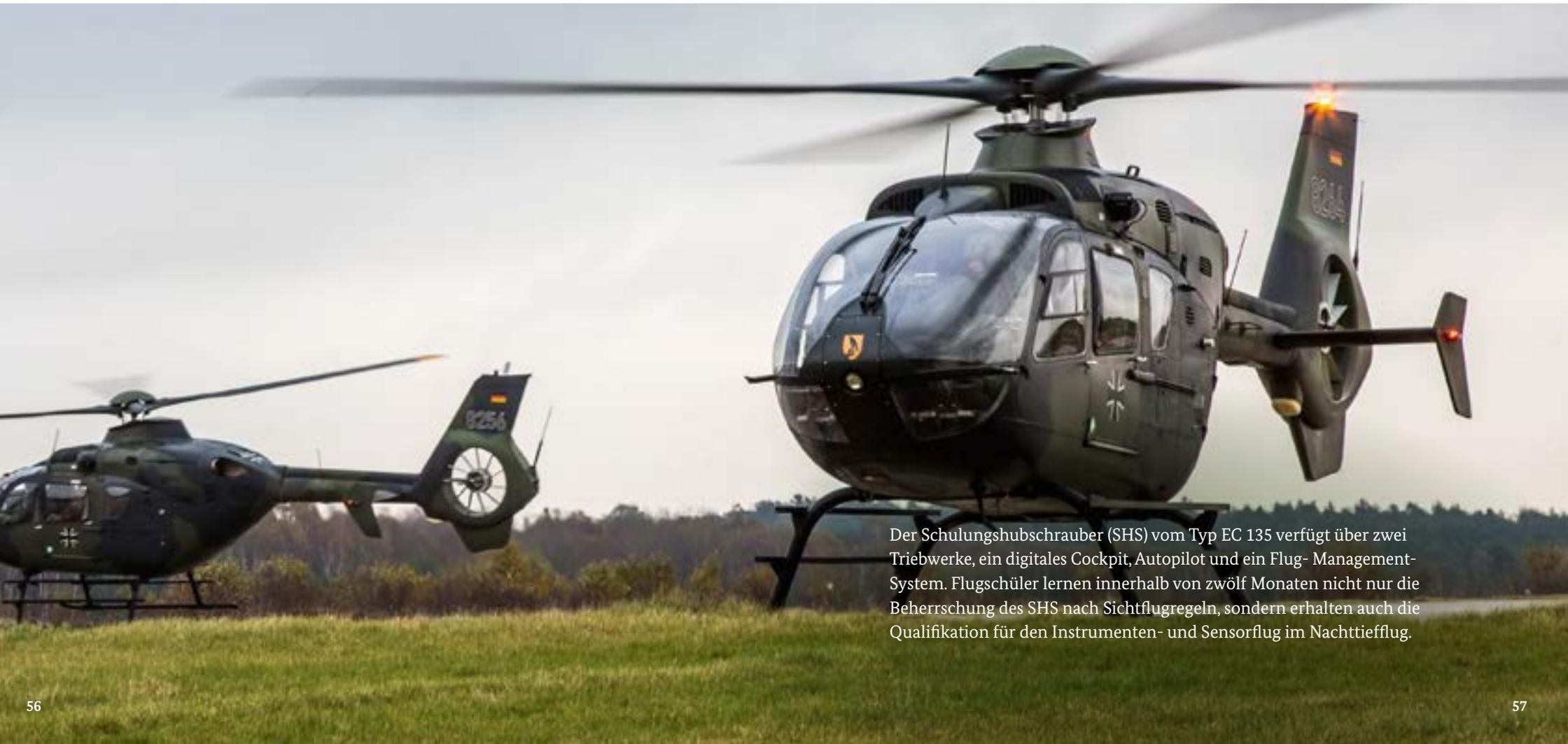
Der Schulungshubschrauber (SHS) vom Typ EC 135 verfügt über zwei Triebwerke, ein digitales Cockpit, Autopilot und ein Flug- Management- System. Flugschüler lernen innerhalb von zwölf Monaten nicht nur die Beherrschung des SHS nach Sichtflugregeln, sondern erhalten auch die Qualifikation für den Instrumenten- und Sensorflug im Nachttiefflug.
