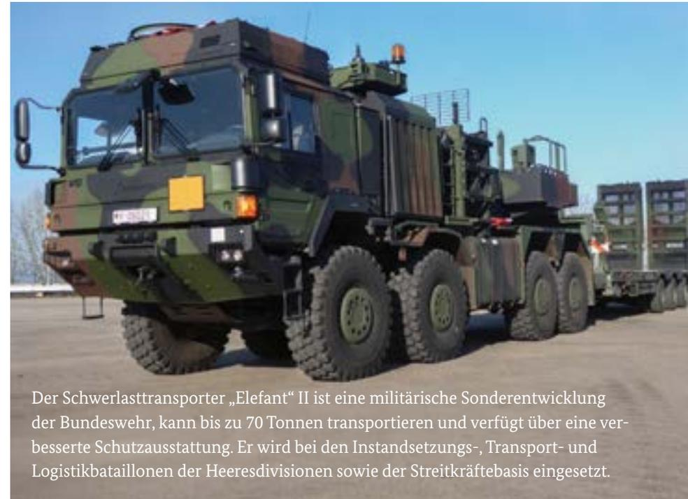
Der Schwerlasttransporter „Elefant“ II ist eine militärische Sonderentwicklung der Bundeswehr, kann bis zu 70 Tonnen transportieren und verfügt über eine verbesserte Schutzausstattung. Er wird bei den Instandsetzungs-, Transport- und Logistikbataillonen der Heeresdivisionen sowie der Streitkräftebasis eingesetzt.
