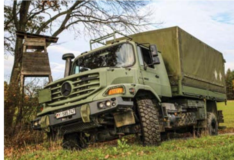
Der „Zetros“ mit der Zuladungsklasse (ZLK) „5 Tonnen“ verfügt im Vergleich zu den bisher von der Bundeswehr im Einsatz genutzten Transportfahrzeugen gleicher Tonnage über einen erheblich gesteigerten Schutz im Bereich der Ballistik sowie gegen Minen und Sprengfallen. Durch eine ABC-Schutzbelüftungsanlage und die Möglichkeit zur Aufnahme einer fernbedienbaren Waffenstation wird der Schutz des Fahrzeuges und damit der Soldatinnen und Soldaten weiter erhöht.
