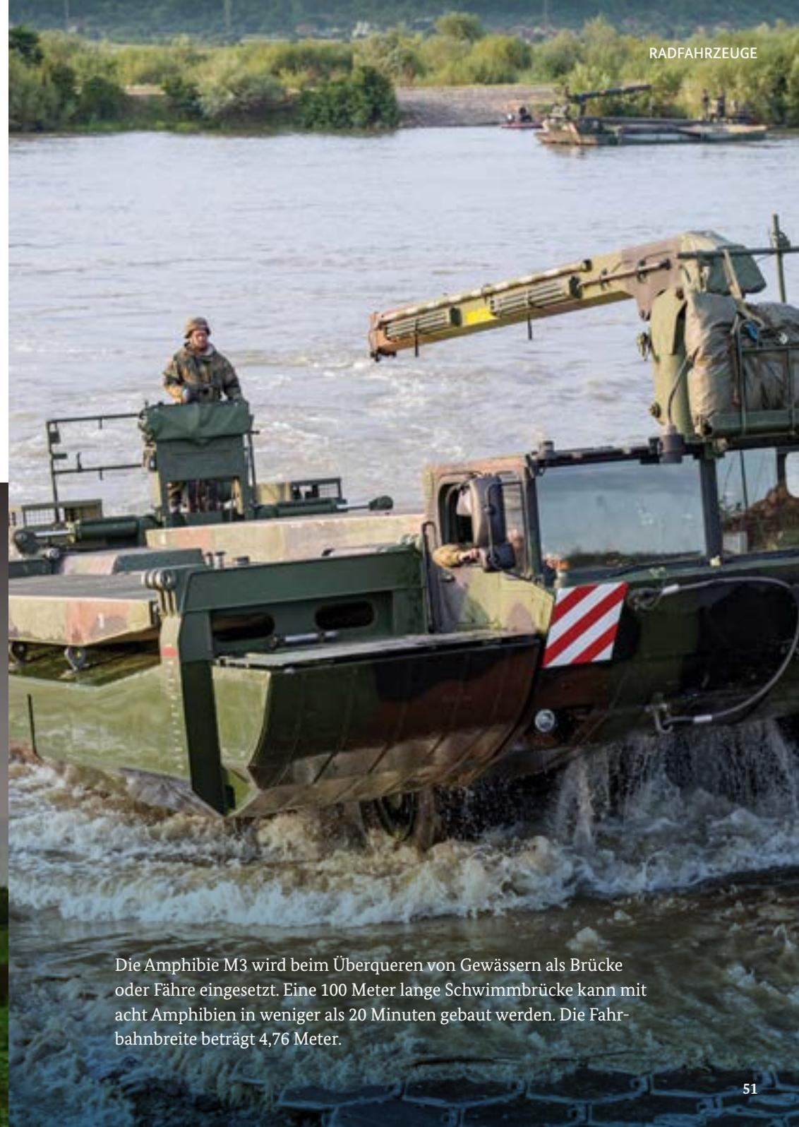
Die Amphibie M3 wird beim Überqueren von Gewässern als Brücke oder Fähre eingesetzt. Eine 100 Meter lange Schwimmbrücke kann mit acht Amphibien in weniger als 20 Minuten gebaut werden. Die Fahrbahnbreite beträgt 4,76 Meter.
