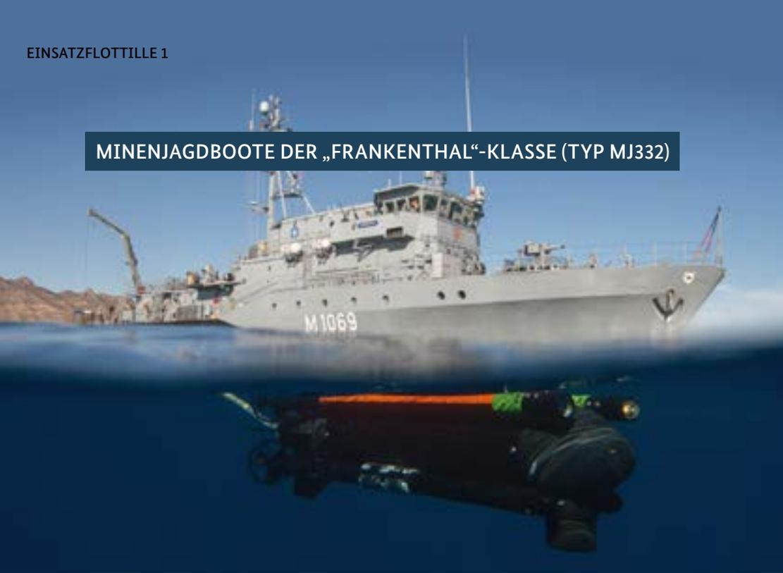
Die Spezialisten, um mit der Bedrohung durch Seeminen umzugehen, sind bei der Deutschen Marine die Boote der „Frankenthal“-Klasse. Alle zehn Minenjagdboote vom Typ MJ332 besitzen zunächst einmal ein Sonar für die Suche nach potenziellen Minen. Unterwasserdrohnen vom Typ „Seefuchs“ können dann die Sprengkörper genau identifizieren und zerstören – egal ob Grund- oder Ankertaumine. Stößt die Technik an ihre Grenzen, wie etwa in flachen Gewässern, setzen die „Frankenthal“-Boote Minentaucher ein.
