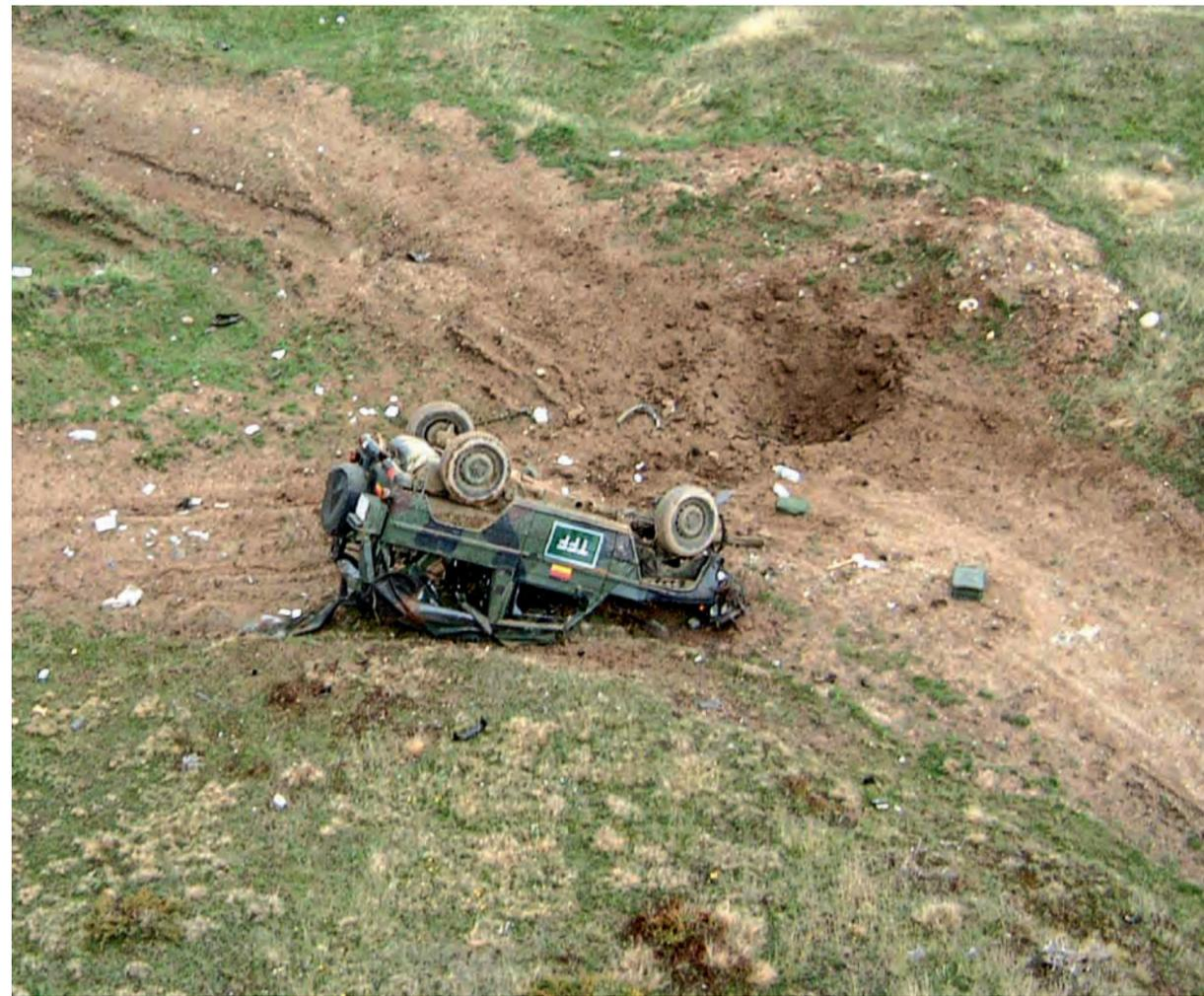
**Als der Wolf** wieder auf den Rädern steht, wird das Ausmaß der Detonation deutlich. Der Motorblock ist herausgerissen worden und liegt einige Meter entfernt auf einem angrenzenden Feld.
