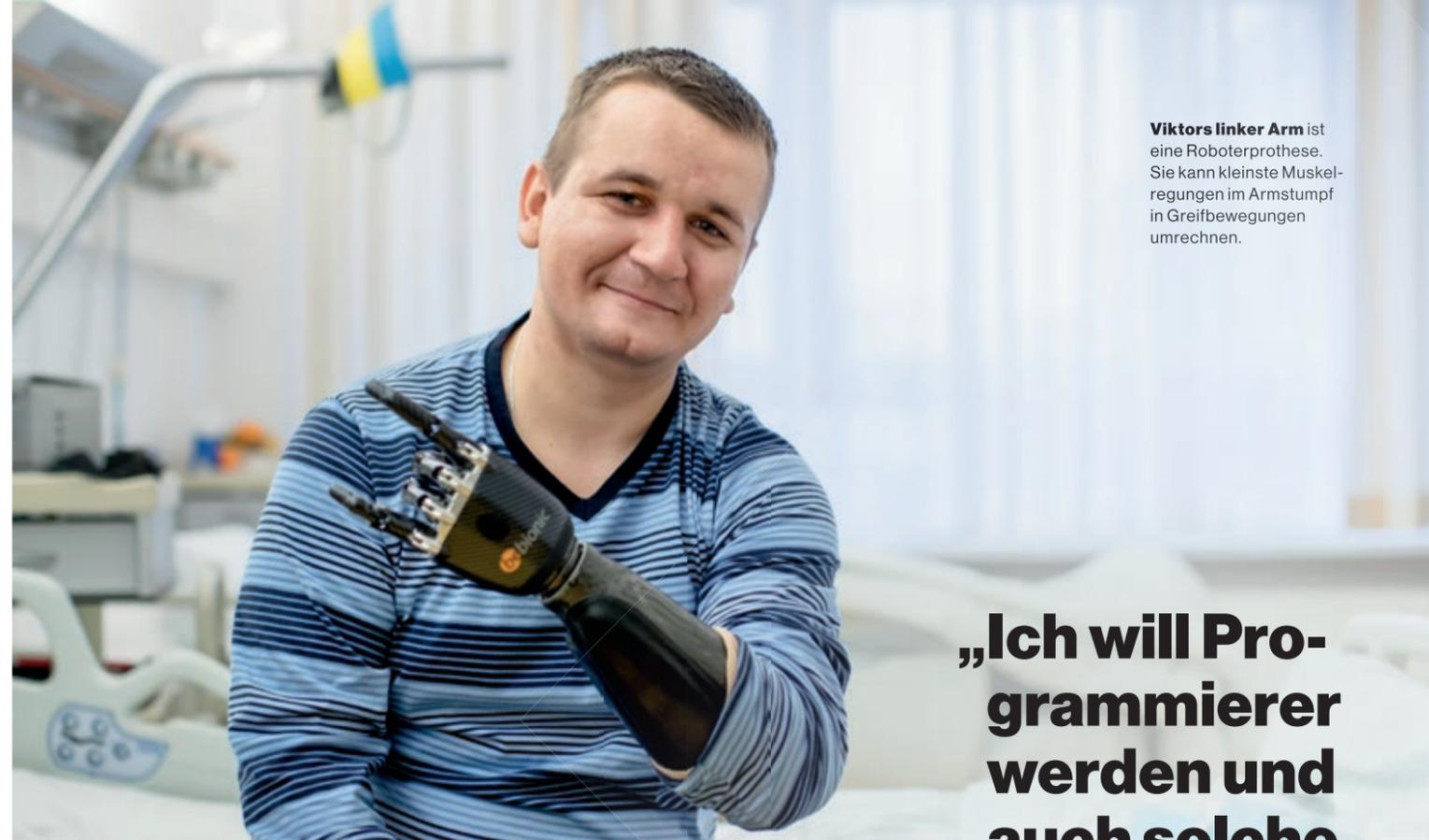
Viktors linker Arm ist eine Roboterprothese. Sie kann kleinste Muskelregungen im Armstumpf in Greifbewegungen umrechnen.
