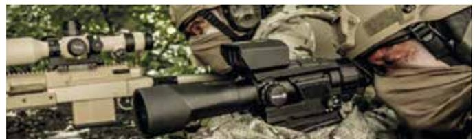
*Die modularen Optiken von HENSOLDT auf dieser Seite lassen sich dank genormten Waffenschnittstellen (MIL-STD 1913 / STANAG 4694) schnell und einfach an der Waffe befestigen, ohne dass zusätzliches Werkzeug benötigt wird. Alle Zieloptiken, Visiere, Spektive, Bildverstärker und Wärmebildgeräte werden in enger Zusammenarbeit mit der Bundeswehr entwickelt und am Standort Wetzlar produziert.*
