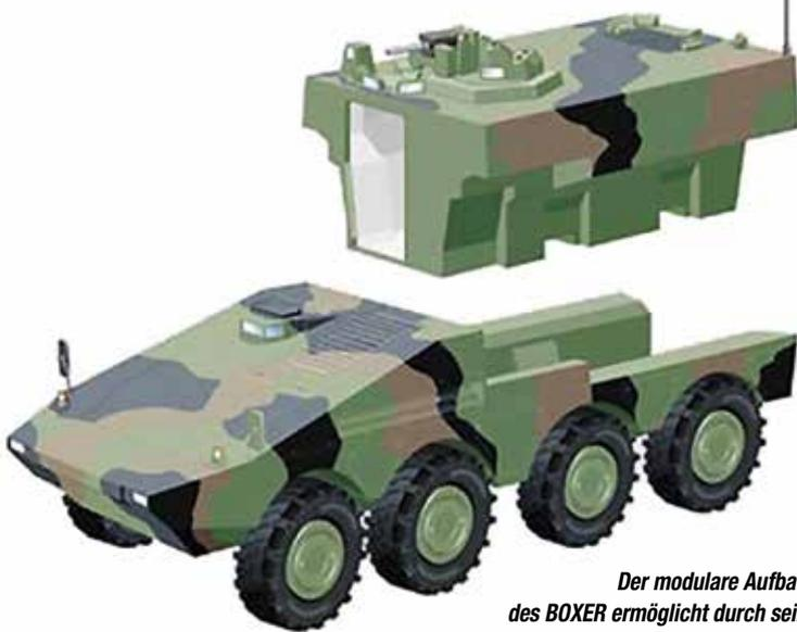
**Der modulare Aufbau des BOXER ermöglicht durch sein einheitliches Fahrmodul und eine Vielzahl spezifisch, schnell wechselbarer Missionsmodule die flexible Anpassung an zukünftige militärische Aufgaben oder sich ändernde Anforderungen.**
