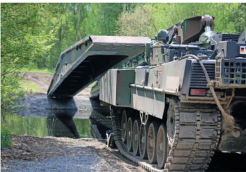
Vorbereitung/Ausfahren der Brücke für das Übersetzen von Fahrzeugen. (Quelle: Bundeswehr)
