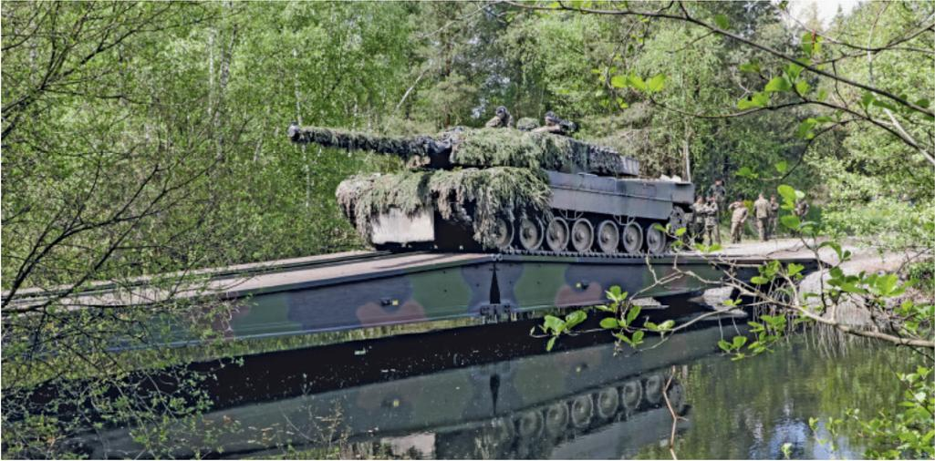
Übersetzen eines KPz Leopard über die Brücke des Leguan. (Quelle: Bundeswehr)
