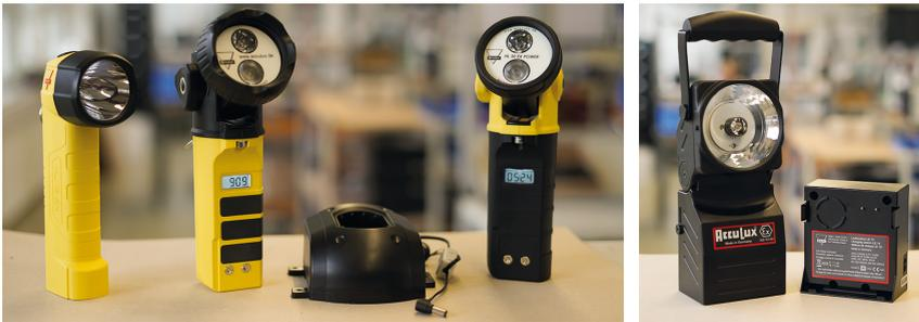
*Vielfältige ATEX zertifizierte Hand- und Sicherheitsleuchten sowie Arbeitsleuchten mit Notlichtfunktion bestimmen das Produktportfolio. Die gezeigte AccuLux EX SLE 16 LED kann in Dauer-, Blink- und Pilotlampenfunktion betrieben werden und als Warnleuchte eingesetzt werden. Die Ladestation verfügt über optimierte Ladetechnik in minimalen Abmaßen, wodurch Montagemöglichkeiten für kleinste Lücken im Kfz-Bereich oder Gebäude für 230 V AC sowie 24/12 V DC bestehen. (Fotos: Witte + Sutor GmbH)*
