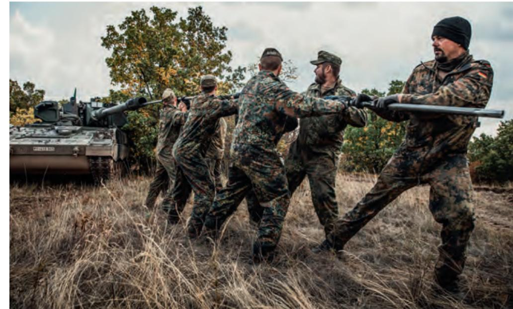
**Die Rohrreinigung** funktioniert ähnlich wie bei einer Handwaffe. Allerdings ist das Reinigungsgerät rund 30 Kilogramm schwer und über vier Meter lang.
