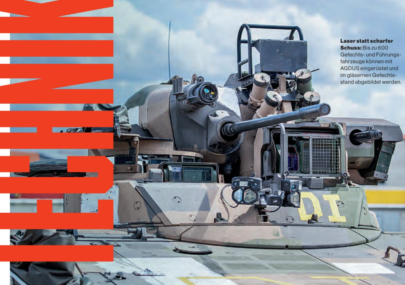
**Laser statt scharfer Schuss:** Bis zu 600 Gefechts- und Führungsfahrzeuge können mit AGDUS ausgerüstet und im gläsernen Gefechtsstand abgebildet werden.
