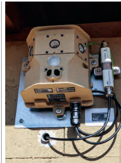
**Durch Häuserwände hindurch:** Ob Beschuss durch Panzer, Panzerfaust oder Handgranate, die MASIE-Sensormodule registrieren die Treffer und übermitteln die jeweilige Wirkung auf die Sensormodule der Einsatzkräfte.
