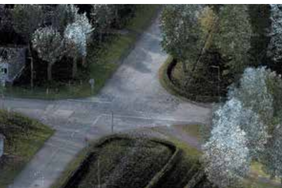
△ Abb. 4: Nachkolorierte Laserpunktwolke einer Kreuzung mit Bäumen. (Quelle: Bundeswehr/ZGeoBw/Anger)
