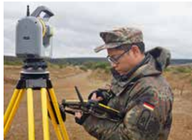
△ Abb. 3: Einmessung der Sprengkrater durch einen Soldaten des Vermessungstrupps. (Quelle: Bundeswehr/ZGeoBw/Anger)
