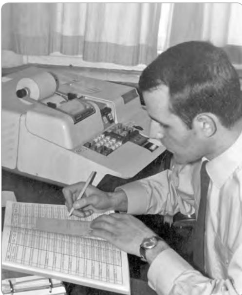
**Abb. B-5-25:** Vermessungsrechner Olivetti Programma (August 1969);
