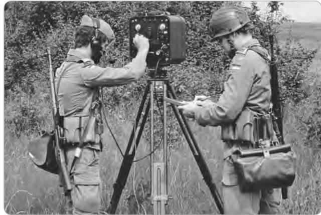
Abb. B-5-57: Entfernungsmessung mit Elometer Tellurometer MRA10, am Gerät Fw Bäcker;
