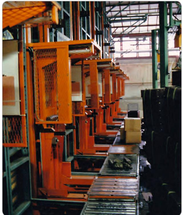
► **Abb. B-7-11:** Das Materiallager 2, Spechthausen, in dem über 1000 t Karten lagerten, war mit einem Regalsystem mit automatischer Förderanlage ausgestattet, Okt. 1990 (Quelle: Schwerdtfeger)
