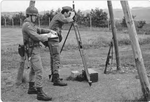
Abb. B-5-56: Richtungsmessung;
