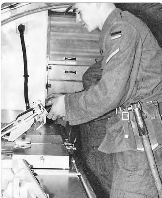
► **Abb. B-5-12:** In einer Übung der Topographielehrbatterie 700: Photogrammeter am Stereotop, etwa 1967/1968 (Quelle: Album Albrecht)
