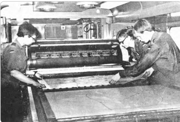
► **Abb. B-5-33:** Die Topographiebatterie 900 (BMVg) hatte für die Unterstützung des HQ BMVg eine Offsetpresse für den Druck großformatiger Lagekarten auf einen Sonderfahrzeug, um 1979 (Quelle: Landmann)
