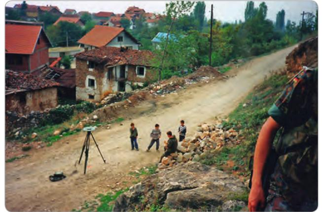
► **Abb. B-4-108 und B-4-109:** Topographiebatterie 900 hatte den Auftrag, ständig MilGeo-Personal für Auslandseinsätze bereitzuhalten. Für das deutsche KFOR-Kontingents im Kosovo wurden im April 2001 Vermessungen im Raum Prizren ausgeführt. Die GPS Fast Static Messung (rechts) weckte Neugier der Dorfjugend. (Quelle TopBttr 900)
