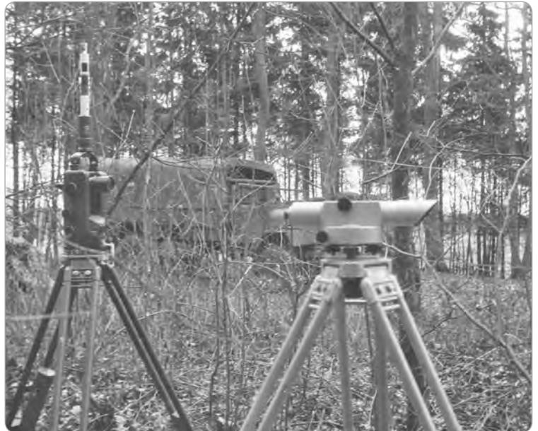
► **Abb. B-4-37:** Instrumente des Vermessungszuges: Theodolit Askania TU 400 (links, mit Zielstab) und Nivelliergerät Zeiss Ni 2 (rechts) (Quelle: Barner)
