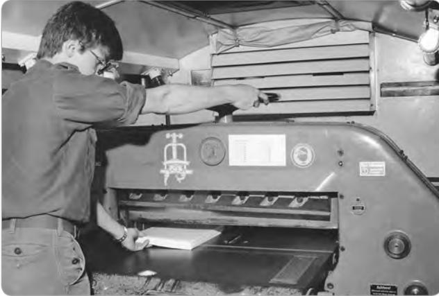
► **Abb. B-5-70:** Drucksachen werden mit der Papierschneidemaschine auf Format gebracht, 1979. (Quelle: Landmann)
