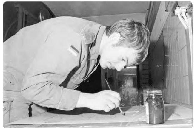
▶ **Abb. B-2-38:** Retusche einer Druckplatte
