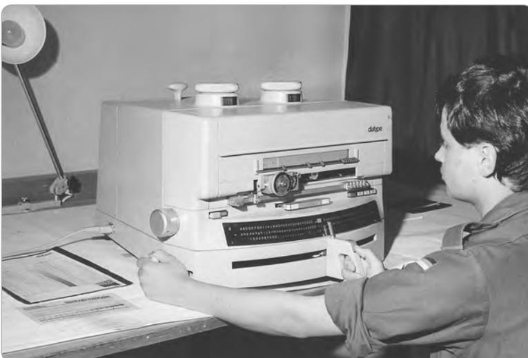
► **Abb. B-5-63:** Kan Wengle beim Setzen von Texten am Lichtsatzgerät Diatype, 1979. (Quelle: Landmann)
