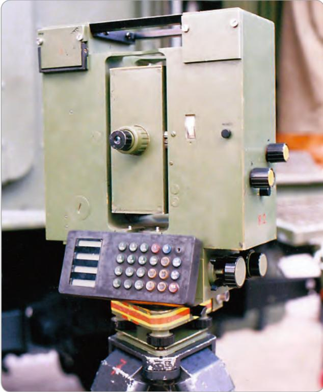
► **Abb. B-7-8:** Zu den geodätischen Instrumenten gehörte das elektro-optische Entfernungsmessgerät RECOTA von Zeiss Jena, Okt. 1990 (Quelle: Schwerdtfeger)
