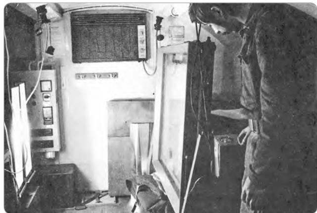
▶ **Abb. B-6-24:** Belichtung mit der Kohlebogenlampe im Sonderanhänger Siebdruck des Kartographiezuges, etwa 1971 (Quelle: Konze)
