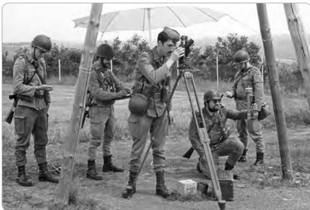
Abb. B-5-60: Astronomische Richtungsbestimmung durch Sonnenbeobachtung, rechts mit Psychrometer Fw Heim.
