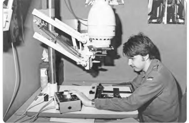
▶ **Abb. B-2-36:** Vergrößerungsgerät in Dunkelkammer
