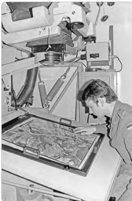
▶ **Abb. B-2-39:** Photogrammeter am Entzerrungsgerät Zeiss SEG V b
