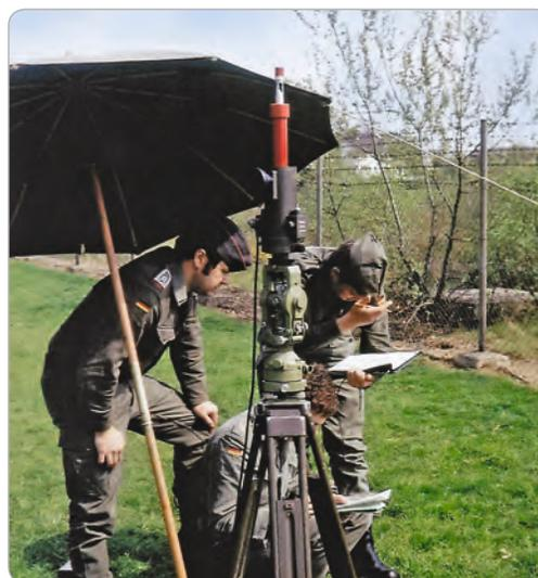
**Abb. B-5-129:** Vermessen mit Aufsatzkreisel Fennel TK4 auf TheodolitWild T2 Bw, 1976
