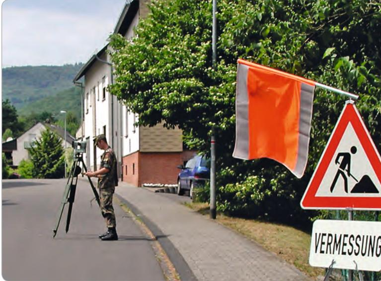
► **Abb. B-4-118** : Vermessung in einer Ortslage, StUffz Müller mit Schnellvermessungsausstattung ELTA 13M, Juni 2001
