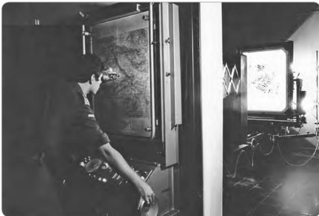
▶ **Abb. B-5-66:** Einstellung der Zwei-Raum-Reproduktionskamera Klimsch K50, OFw Baumann, 1979. (Quelle: Landmann)
