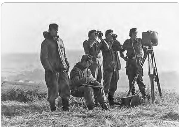
► **Abb. B-3-12:** Der MilGeo-Dienst unterstützte die Landesvermessungsämter bei der Neumessung von Dreiecksketten in Nordbaden. Topographiebatterie 201 war 1965 im Einsatz bei elektronischen Entfernungsmessungen mit dem Tellurometer MRA 3, sowie ...
