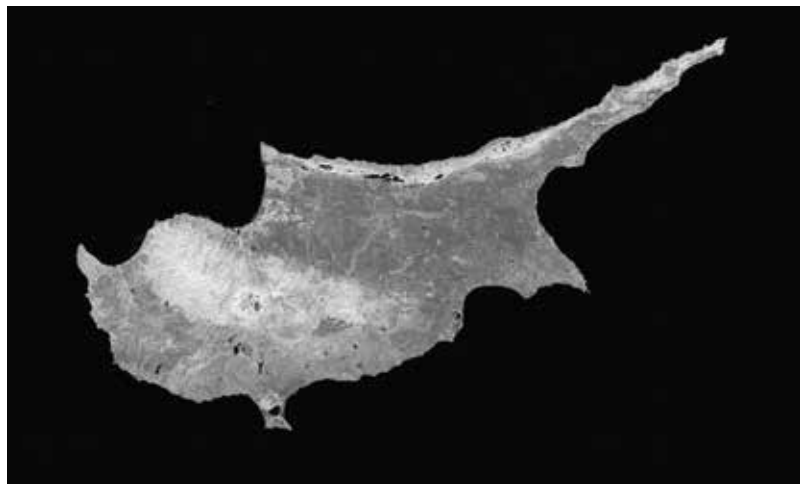
△ Abb. 12: NDVI-Index (hell = hohe Vegetationsbedeckung, dunkel = schwache Vegetationsbedeckung). (Quelle: Bundeswehr/ZGeoBw/Frank Struwe)
