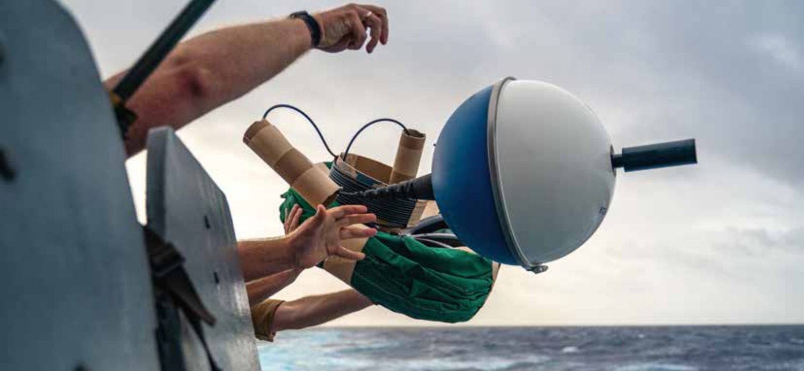
△ Abb. 1: 20 Kilogramm wiegt eine Boje. Die weiß-blaue Kugel schwimmt auf der Meeresoberfläche. Der grüne Treibanker schwimmt ca. 10 Meter unter der Wasseroberfläche und sorgt dafür, dass die Boje mit der Strömung treibt. (Quelle: Bundeswehr/Marcus Mohr)
