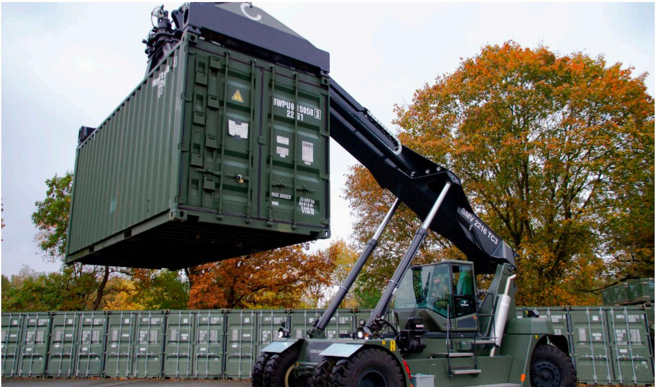
Containerstapler im Einsatz: Um Material ein- und auszuladen, kommen Feldumschlaggeräte bzw. Stapler unterschiedlicher Nutzlast zum Einsatz.
