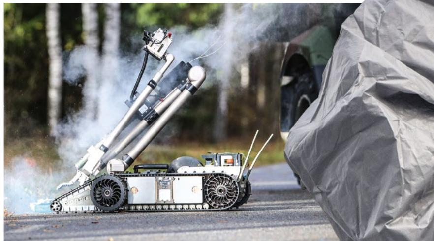
→ Ferngesteuerte Roboter sorgen für das kontrollierte Vernichten von Sprengmitteln.
