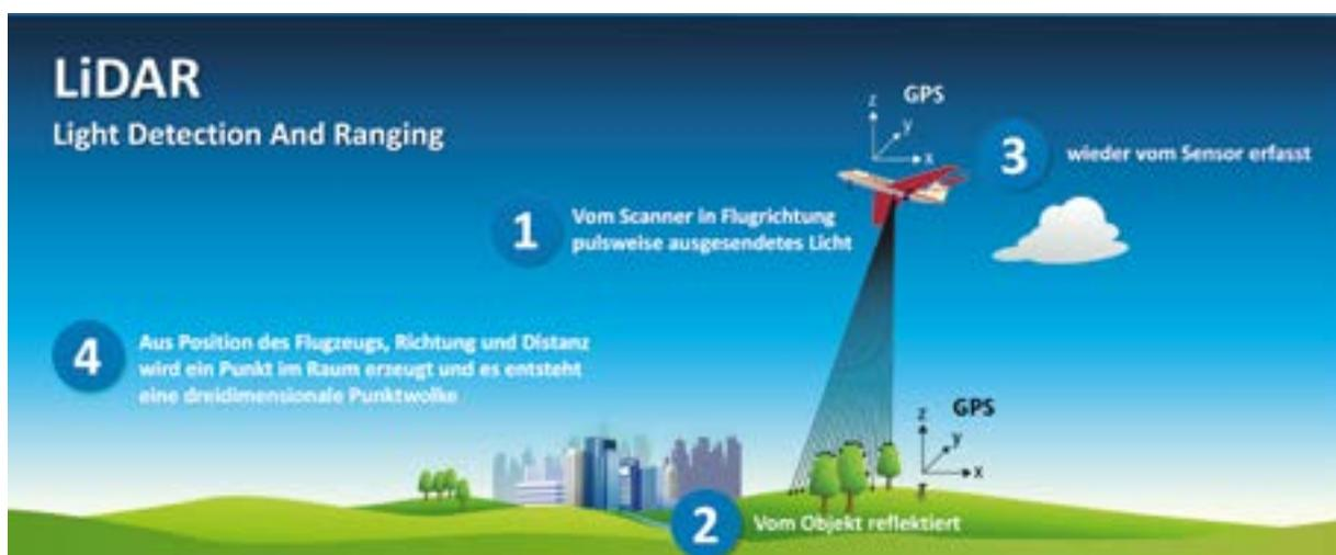
△ **Abb. 3:** Befliegung mit LiDAR. (Quelle: BKG)
