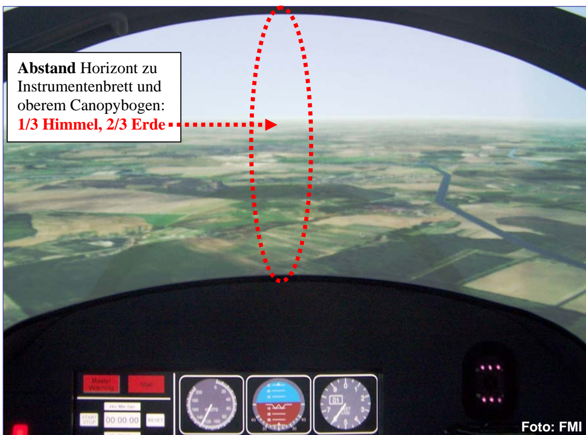
Bild 6: Horizontbild im Sinkflug mit 1500 FPM und 130 KNOTS
