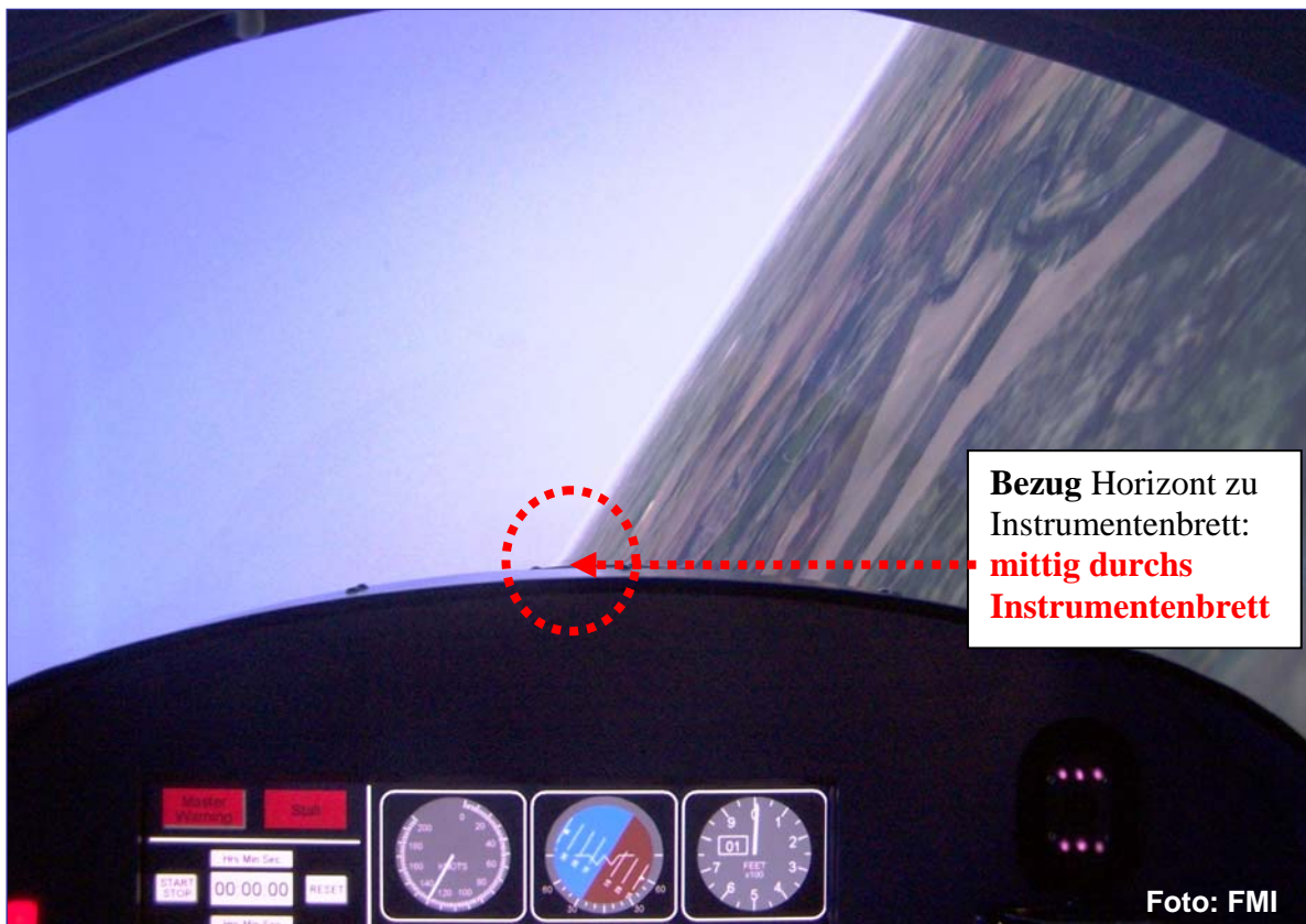
Bild 10: Horizontbild beim rechten Kurvenflug mit 60° Bank bei konstanter Höhe
