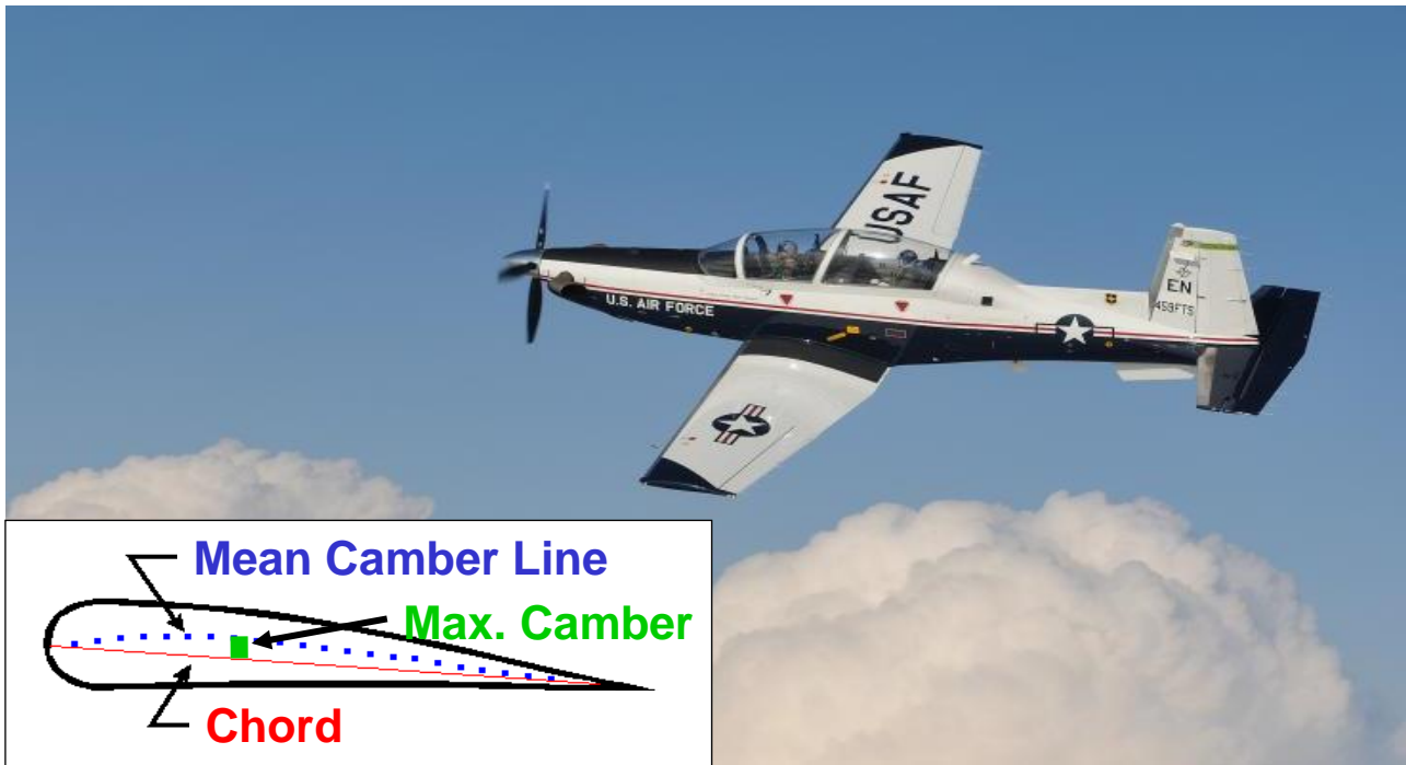
T-6 A Texan II, Schematische Darstellung der Skelettlinie , maximaler Wölbung und Profilsehne .
