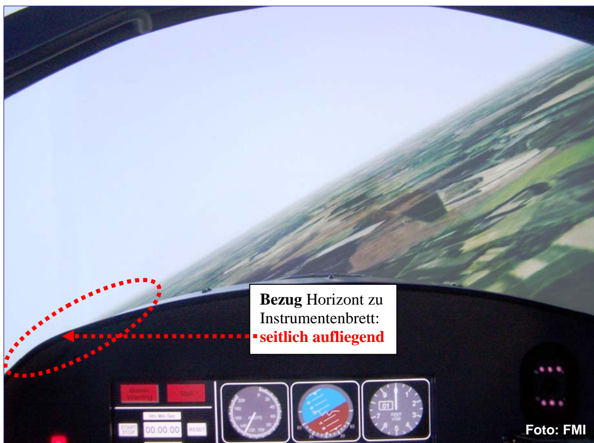
Bild 8: Horizontbild beim rechten Kurvenflug mit 30° Bank bei konstanter Höhe
