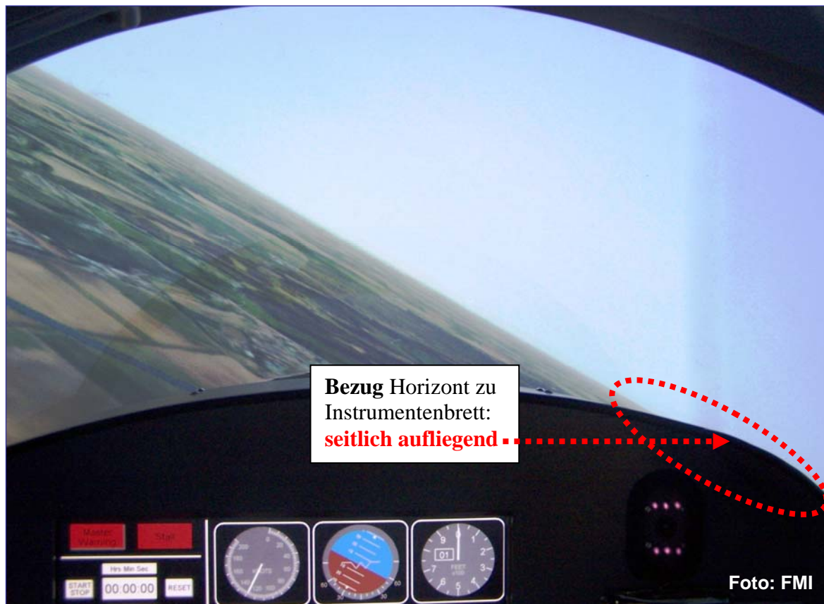
Bild 7: Horizontbild beim linken Kurvenflug mit 30° Bank bei konstanter Höhe
