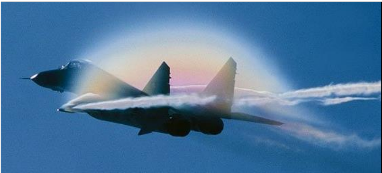
Eine MiG-29 Fulcrum mit sichtbarer Luftströmung.
