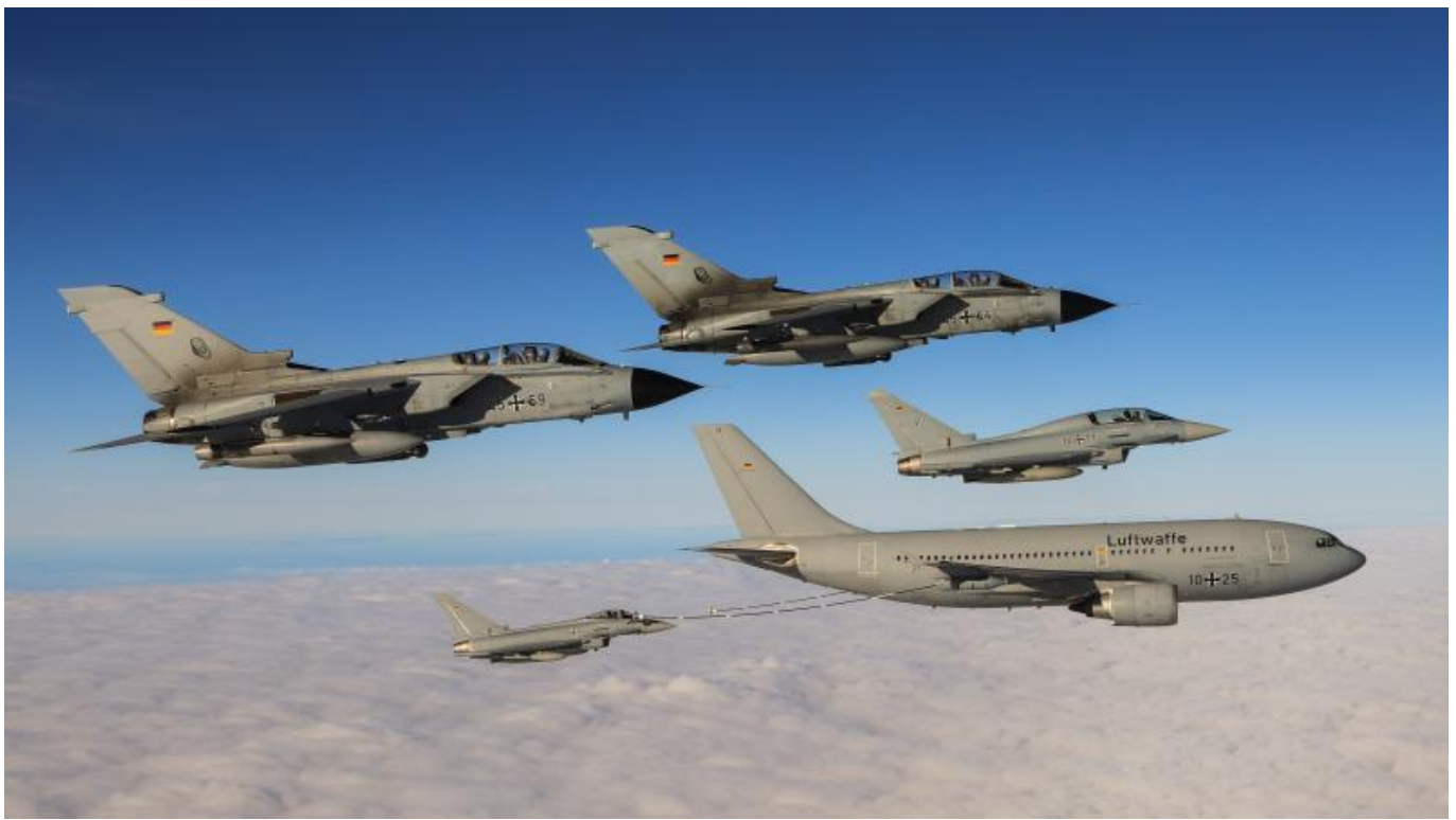
2 Tornados und 2 Eurofighter beim Air-to-Air-Refueling am A310 MRTT
