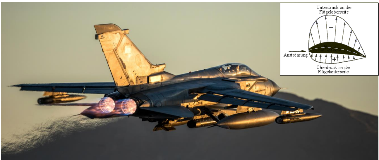
Tornado, Auftriebsverteilung am Tragflügel eines Flugzeugs
