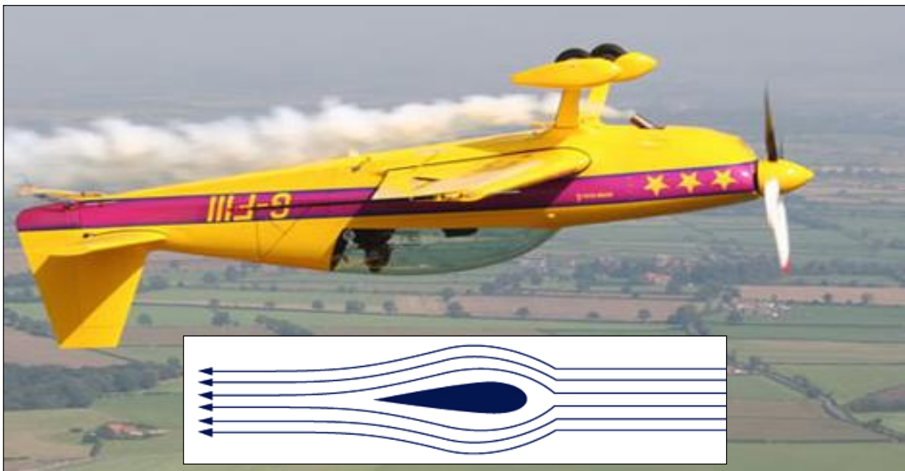
Ein kunstflugtaugliches Flugzeug vom Typ Walter Extra 300 mit symmetrischem Profil.
