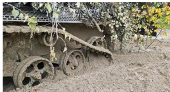
△ Abb. 3: Tückischer Wüstensand führt zum Abwurf der Panzerkette. (Quelle: Pionierschule)
