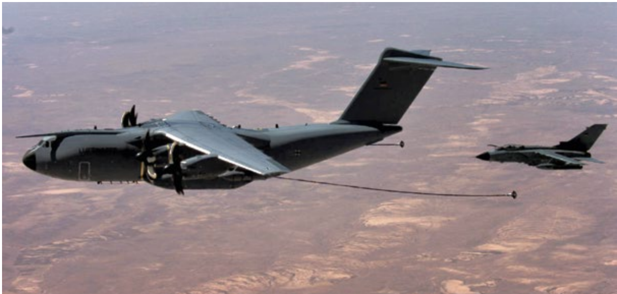
△ Abb. 3: A400M in der Betankungsversion AAR (Air to Air Refueling) kurz vor der Betankung eines Aufklärungstornados im Rahmen Counter Daesh. (Quelle: © Bundeswehr/Yvonne Albert)
