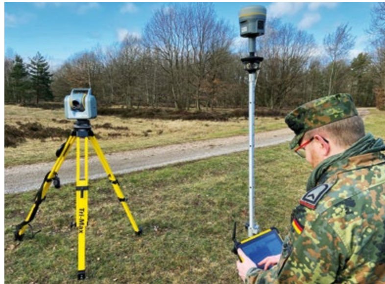
△ Abb. 13: Einsatzvermesser bei der Bedienung der Totalstation Trimble SX10 im Außendienst. (Quelle: ZGeoBw/Keller)
