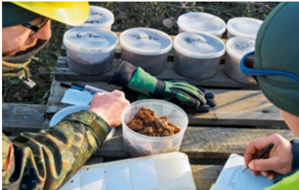
△ Abb. 4: Bodenprobengefäße, Befüllen und Beschriften der Proben zur Übergabe und Versand an das mobile Chemielabor der SABCAbwGSchAufgBw. (Quelle: Schule ABC-Abwehr und Gesetzliche Schutzaufgaben Bereich Zentrale Unterstützung - Informationsbereitstellung)
