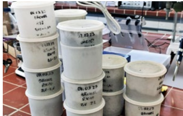
△ Abb. 2: Aktuelle Bodenproben März 2023 vom NATO-Flugplatz Büchel, im stationären Chemielabor der SABCAbwGSchAufgBw, zur Untersuchung auf Bodenkontamination. (Quelle: Schule ABC-Abwehr und Gesetzliche Schutzaufgaben, Bereich Zentrale Unterstützung – Informationsbereitstellung)
