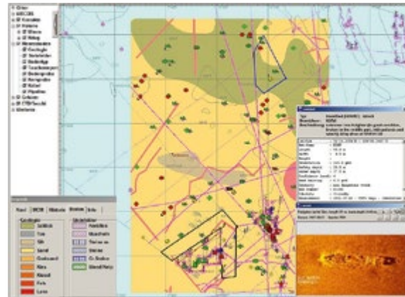
△ Abb. 6: Auszug aus einer Tactical Map mit Informationen unter anderem zur Beschaffenheit des Meeresbodens, Lage von Minen und Schiffswracks. (Quelle: Bundeswehr/MarKdo MGeo5)
