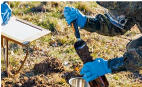
△ Abb. 5: Protokollnahme und Befüllung Bodenprobe zur Untersuchung auf Radioaktivität mit anschließender Übermittlung an das Physiklabor der SABCAbwGSchAufgBw. (Quelle: Schule ABC-Abwehr und Gesetzliche Schutzaufgaben Bereich Zentrale Unterstützung – Informationsbereitstellung)
