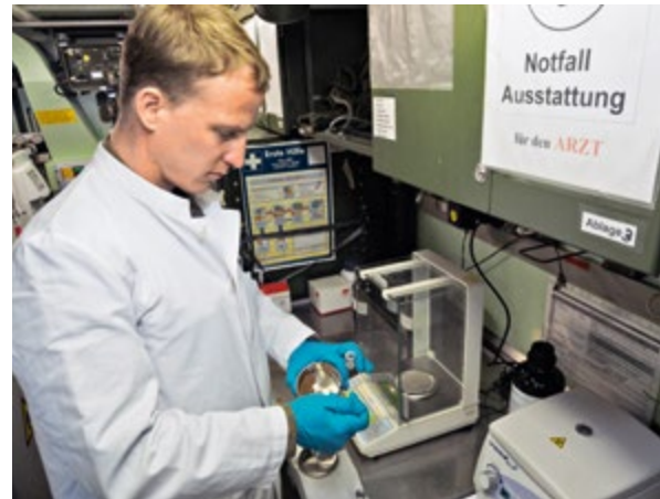
△ Abb. 7: Vorbereiten der Bodenproben zur Analyse im mobilen Laborcontainer durch das Personal des Dezernats Chemie der SABCAbwGSchAufgBw. (Quelle: Schule ABC-Abwehr und Gesetzliche Schutzaufgaben Bereich Zentrale Unterstützung – Informationsbereitstellung)
