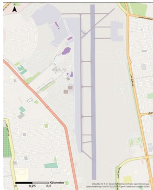
△ Abb. 1: Exemplarische Darstellung des Flughafens Khartoum über verschiedene Zoomstufen in der BaseMap. Die Generalisierung der Daten erfolgt über den Stil und nicht über die Daten, weshalb man von einer Pseudo-Generalisierung spricht. (Quelle: ZGeoBw)
