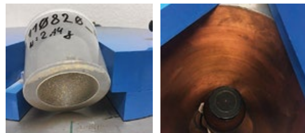
△ Abb. 8/9: Bodenproben zur Analyse im stationären Labor Dezernat Physik am Standort Sonthofen, Untersuchung auf Radioaktivität. (Quelle: Schule ABC-Abwehr und Gesetzliche Schutzaufgaben Bereich Zentrale Unterstützung – Informationsbereitstellung)
