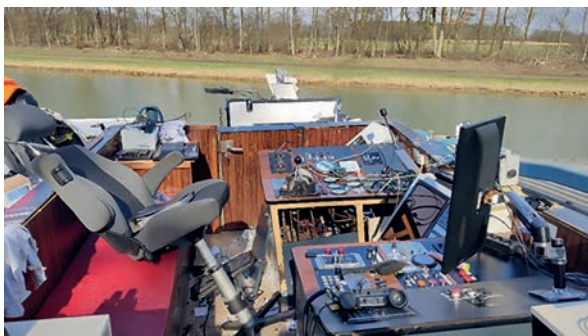
Ein beschädigtes Steuerhaus nach Brückenanfuhrung gramm bei den Wasser- und Schifffahrtsämtern statistisch erfasst.
