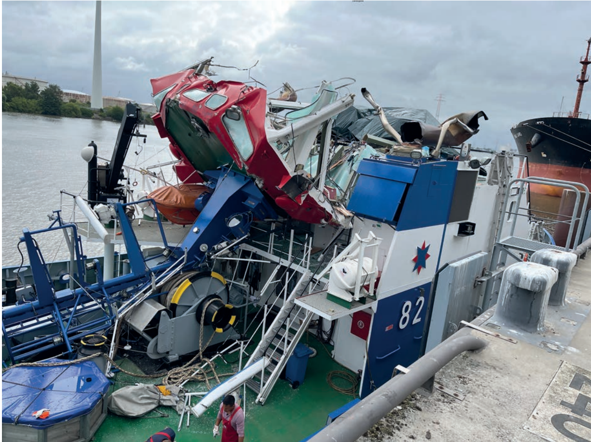
Die Aufbauten und Steuerhaus des Schleppers „Fairplay 82“ nach der Kollision mit Kattwykbrücke
