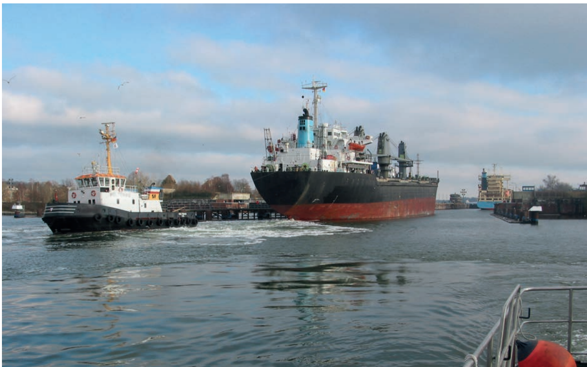
Ein Seeschiff läuft unter Schlepperassistenz in eine Schleuse ein
