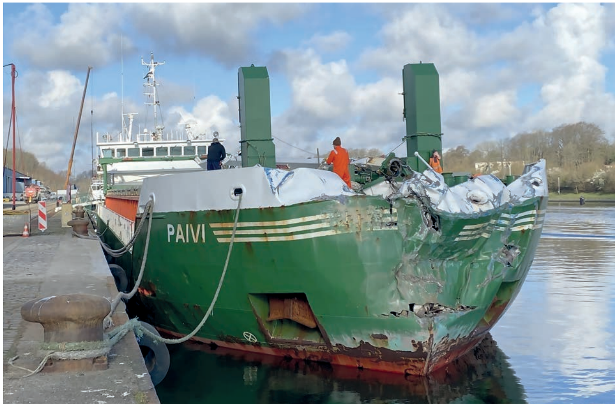
Der Bug von „Paivi“ nach der Kollision mit „Bjoerkoe“
