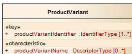
Abbildung 34: S3000L-Datenmodell - Darstellung einer Klasse
