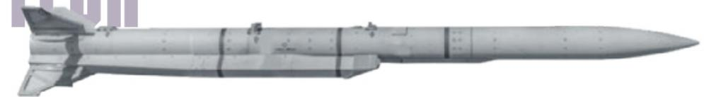
**Länge** 3,67 M | **Spannweite** 0,64 M | **Gewicht** 180 KG
