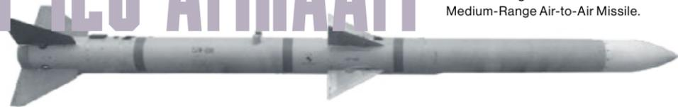
**Länge** 3,66 M | **Spannweite** 0,64 M | **Gewicht** 160 KG
