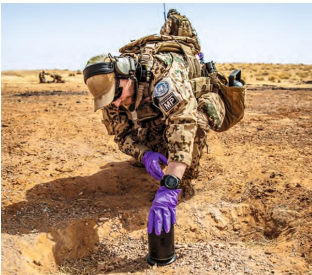
**Weapons Intelligence Team** Mit nur drei Messpunkten der 360-Grad-Kamera kann der Erheber und Ermittler in Mali einen gesamten Explosionskrater vermessen und Erkenntnisse über die Sprengstoffart erlangen.
