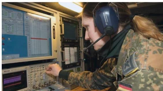
**Eine Soldatin bei der Erfassung, Ortung und Auswertung elektromagnetischer Ausstrahlungen: Im Transportpanzer Fuchs (Radio Multiband) werden die erfassten Radarfrequenzen ausgewertet**
