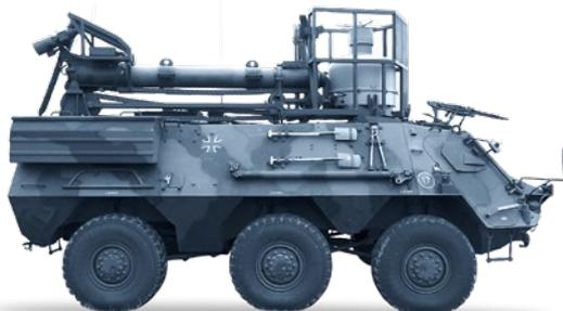
Die Kampfwert-Steigerung Radio Multiband (KWS RMB) ist eine ganz besondere Variante des Transportpanzers Fuchs. Mit dem System KWS RMB mit verbesserter Antennenanlage können Radarsignale erfasst, anpeilt und ausgewertet werden.
