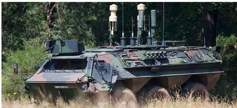
Auf einem Transportpanzer Fuchs aufgebautes, mobil einsetzbares und geschütztes Störsystem, das gegen per Funk fernausgelöste Sprengsätze wirkt
