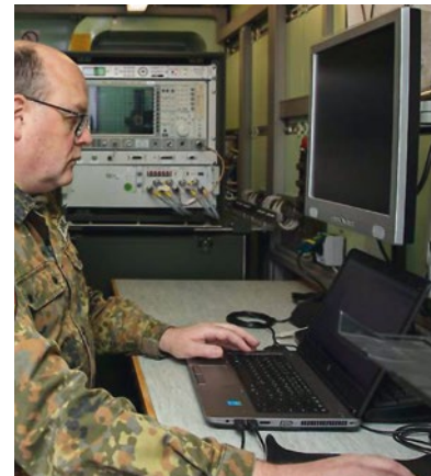
Die Mobilien Abstrahlprüfteams messen die elektromagnetische Strahlung von Systemen der Bundeswehr mit dem Ziel herauszufinden, ob diese zum Beispiel aufgeklärt werden können
