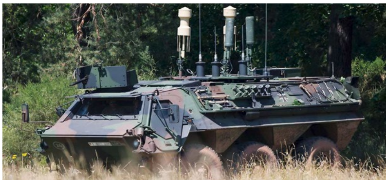
Auf einem Transportpanzer Fuchs aufgebautes, mobil einsetzbares und geschütztes Störsystem, dass gegen per Funk fernausgelöste Sprengsätze wirkt
