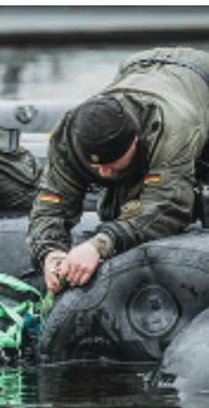
An den Hebesäcken werden Leinen befestigt, an denen der Motor aus dem Wasser gezogen wird.
