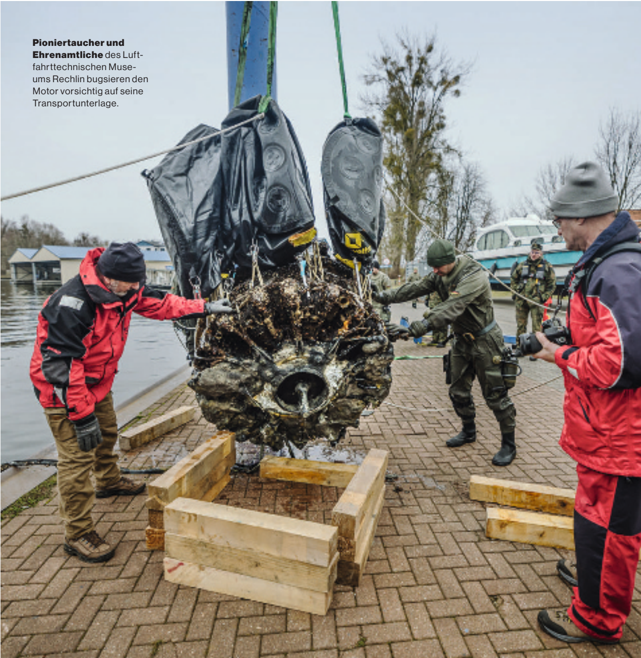
An den Hebesäcken werden Leinen befestigt, an denen der Motor aus dem Wasser gezogen wird.
