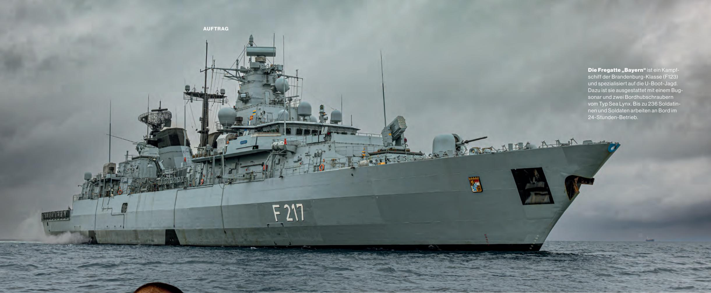
Die Fregatte „Bayern“ ist ein Kampfschiff der Brandenburg-Klasse (F123) und spezialisiert auf die U-Boot-Jagd. Dazu ist sie ausgestattet mit einem Bugsonar und zwei Bordhubschraubern vom Typ Sea Lynx. Bis zu 236 Soldatinnen und Soldaten arbeiten an Bord im 24-Stunden-Betrieb.
