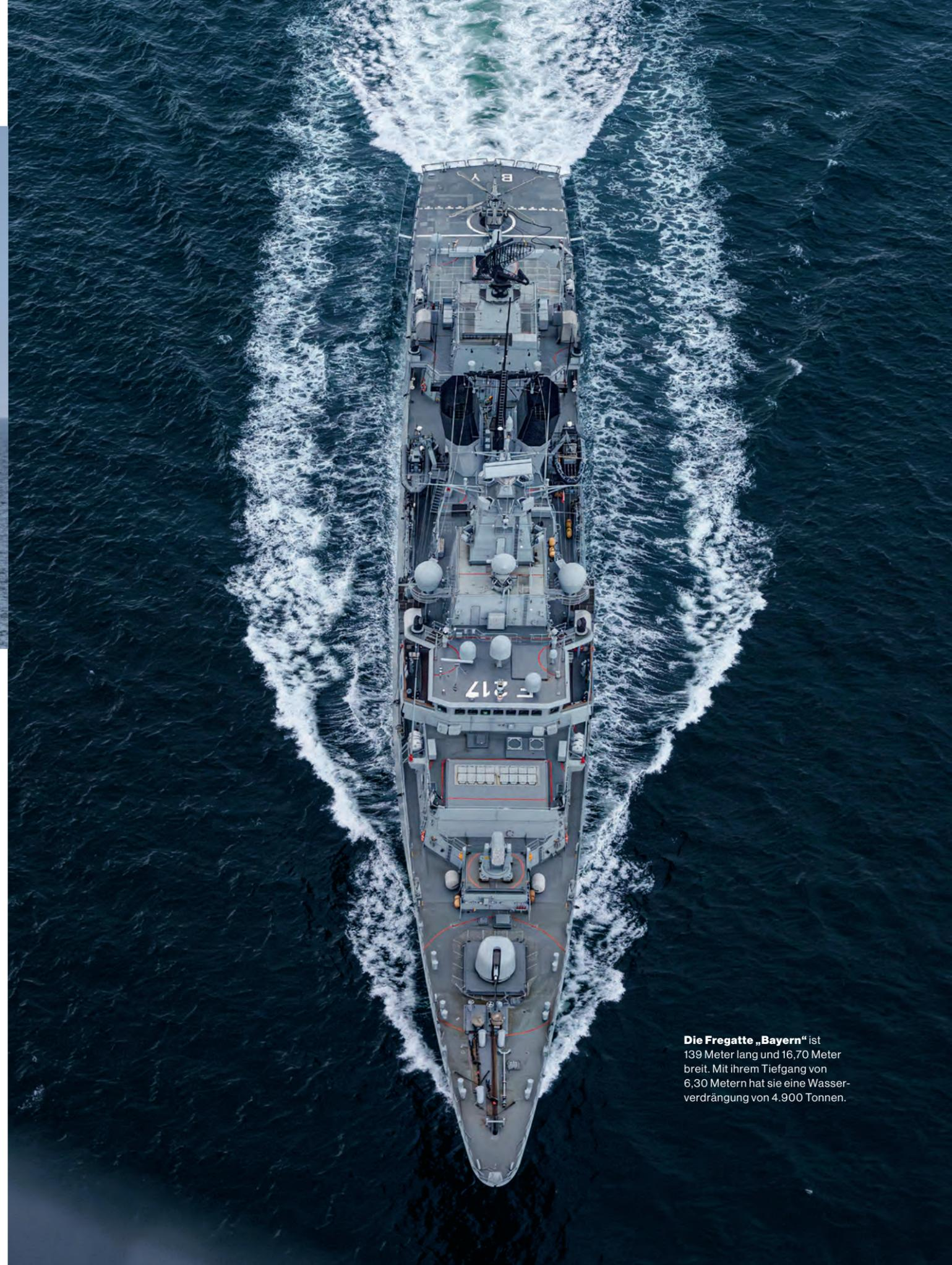
Die Fregatte „Bayern“ ist 139 Meter lang und 16,70 Meter breit. Mit ihrem Tiefgang von 6,30 Metern hat sie eine Wasserdrängung von 4.900 Tonnen.
