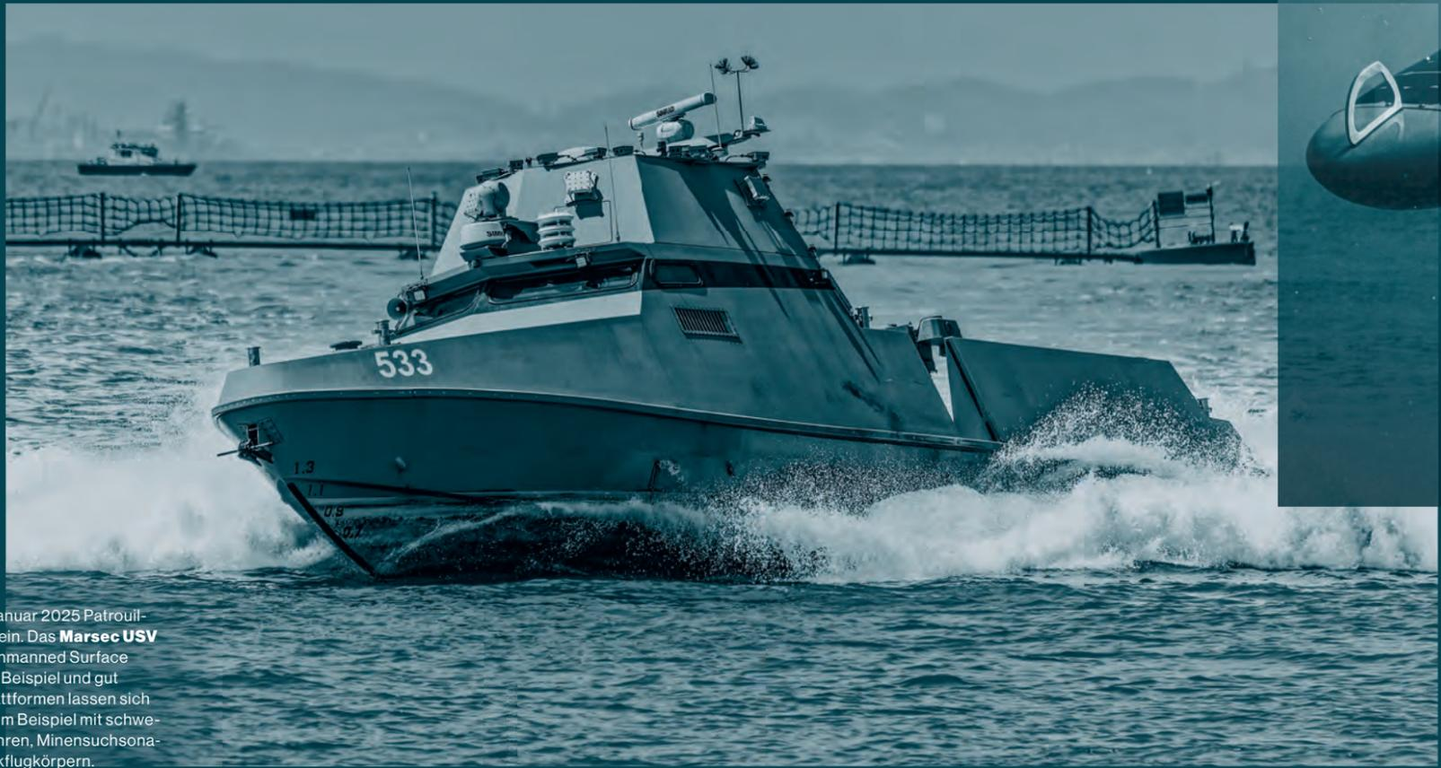
Singapur setzt seit Januar 2025 Patrouillenboote ohne Crew ein. Das **Marsec USV** (Maritime Security Unmanned Surface Vessel) ist ein FCSS-Beispiel und gut 17 Meter lang. Die Plattformen lassen sich flexibel ausrüsten, zum Beispiel mit schweren Maschinengewehren, Minensuchsonaren oder kleinen Lenkflugkörpern.
