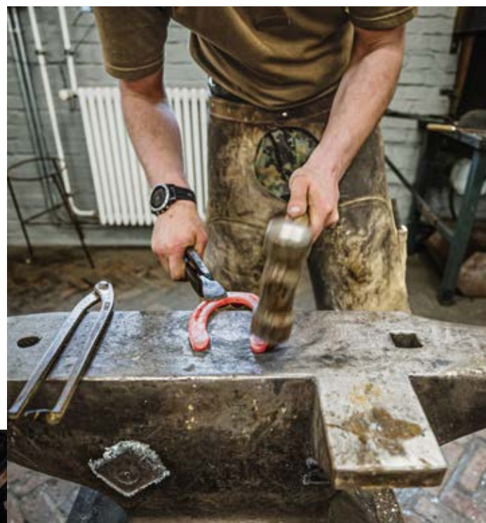
Der Hufschmied der Tragtierkompanie formt das Hufeisen, damit es beim Beschlagen perfekt auf den Huf des Mulis passt. Dazu nutzt er Hammer und Amboss, wie es seit Hunderten von Jahren gemacht wird.
