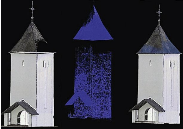
△ Abb. 3: Punktwolken (v. l. n. r.) aus SX10, Photogrammetrie und verknüpft (Quelle: eigene Aufnahme 2025)
