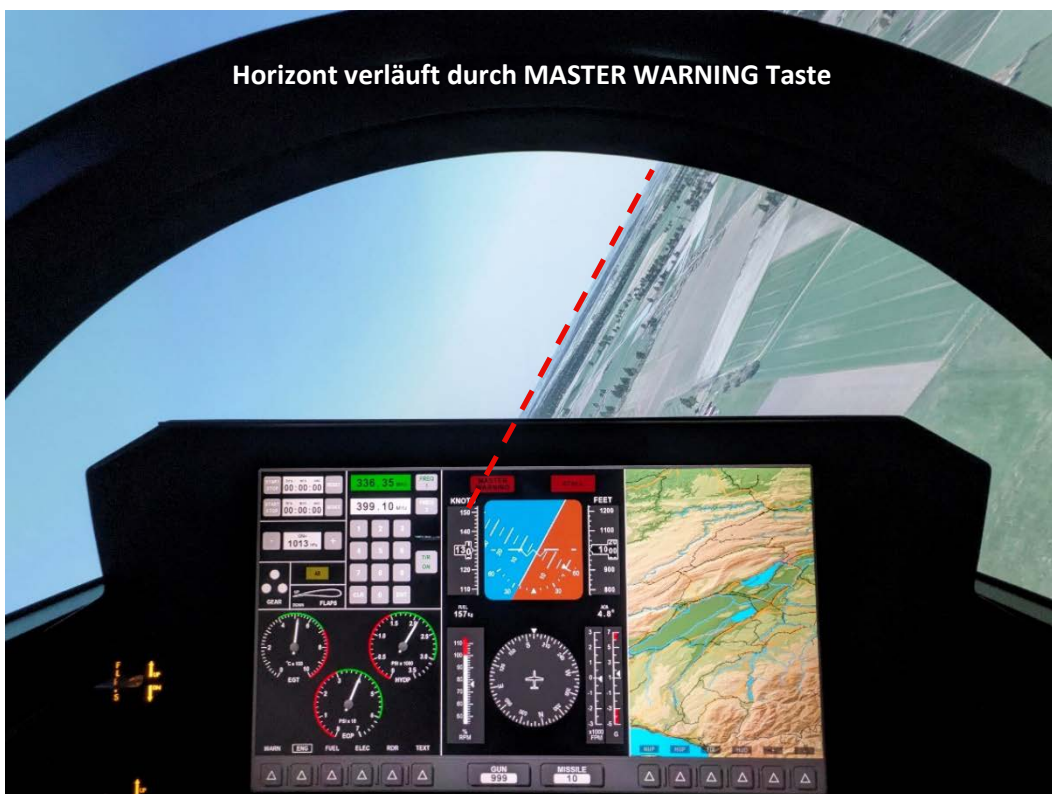
Bild 10: Horizontbild beim rechten Kurvenflug mit 60° Bank bei konstanter Höhe
