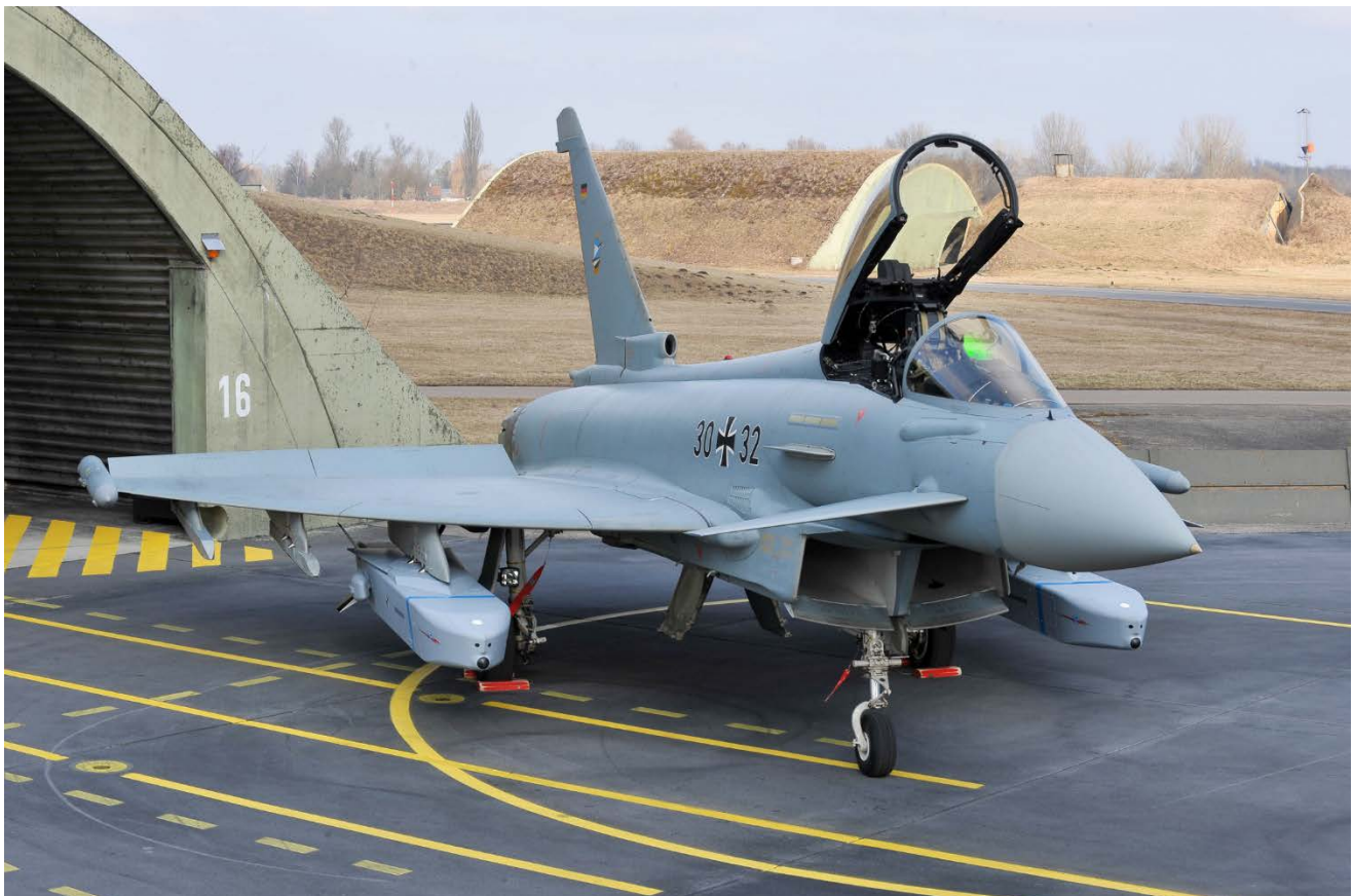
Abb. 12: Einzelne Bauteile wie Außentanks, Bewaffnung, Fahrwerk, Landeklappen und aerodynamische Bremsen in ausgefahrener Stellung erzeugen Form- und Reibungswiderstand. Die gegenseitige Beeinflussung ihrer Luftströme wird Interferenzwiderstand genannt (Eurofighter Typhoon beladen mit zwei TAURUS KEPD350)
