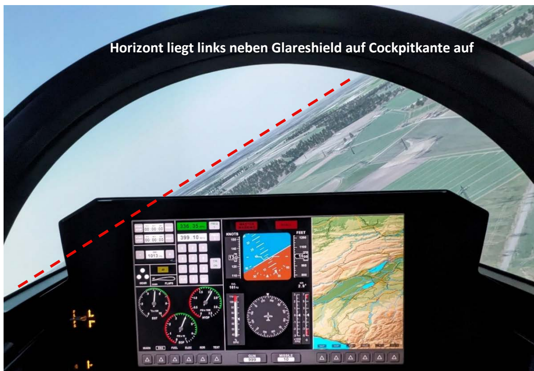
Bild 8: Horizontbild beim rechten Kurvenflug mit 30° Bank bei konstanter Höhe
