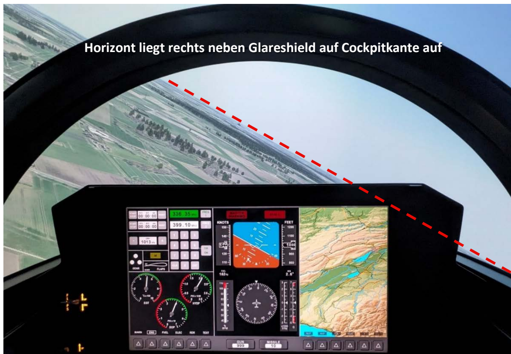
Bild 7: Horizontbild beim linken Kurvenflug mit 30° Bank bei konstanter Höhe
