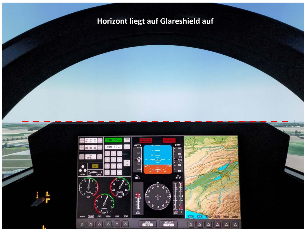
Bild 3: Horizontbild nach dem Abheben bis zum Level-Off
