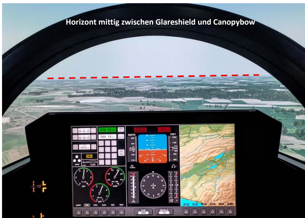
Bild 4: Horizontbild im Reiseflug mit 130 KNOTS
