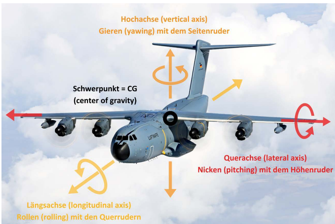
Abb. 15: Die drei Achsen des Flugzeugs (Hoch-, Längs- und Querachse) kreuzen sich im Schwerpunkt (A400m)
