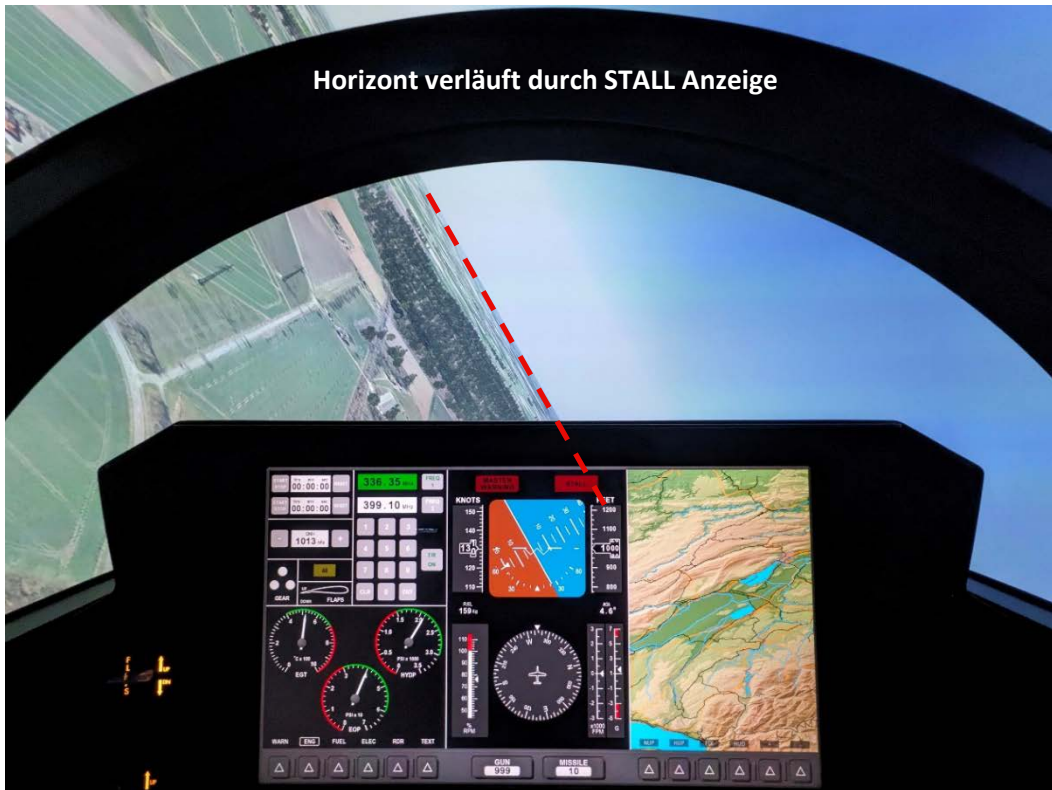
Bild 9: Horizontbild beim linken Kurvenflug mit 60° Bank bei konstanter Höhe
