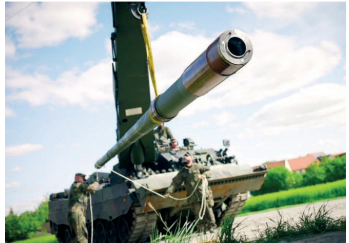
Mit Unterstützung eines Bergepanzers wird das Rohr eines Leopard 2A6 ausgetauscht.
