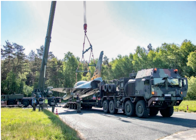
Millimeterarbeit auf Rädern. Der Rumpf eines Eurofighters wird für seinen Weitertransport auf einem Schwerlasttransporter vorbereitet.
