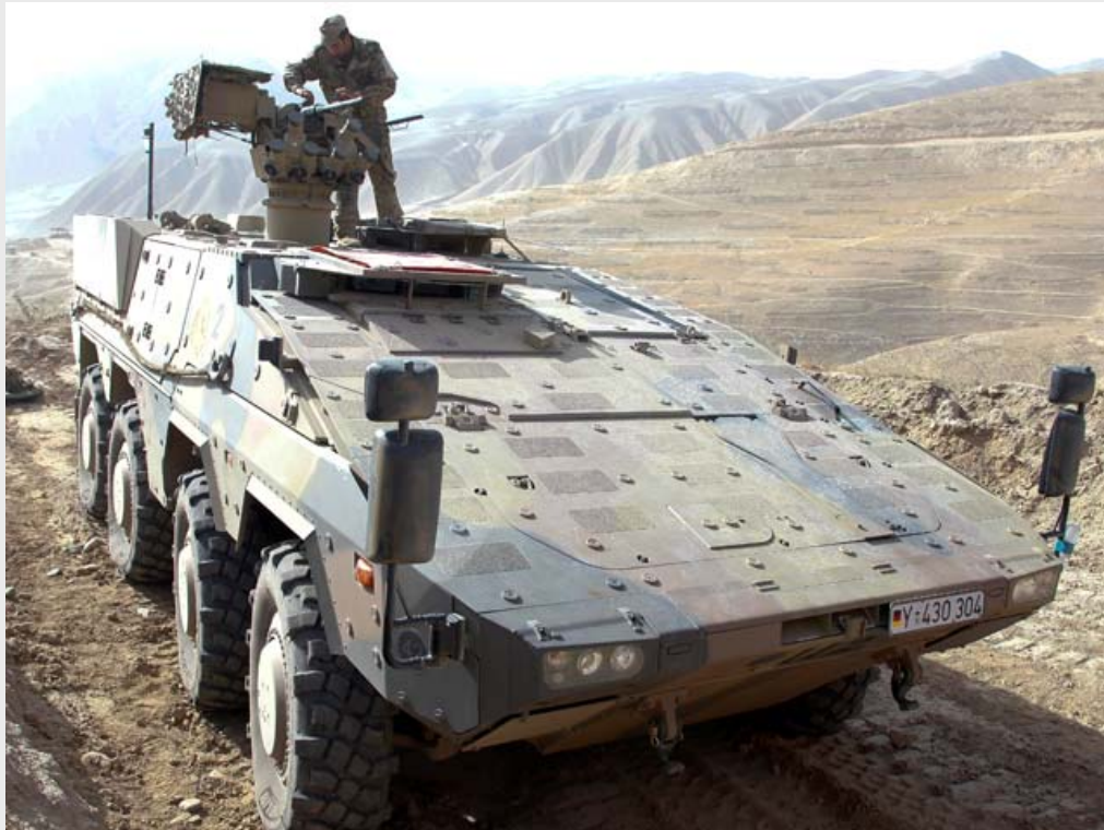
ISAF-Einsatz: GTK Boxer - 32 Tonnen schwer und bis zu 100 Kilometer schnell (Quelle: Bundeswehr/Krumbach)
